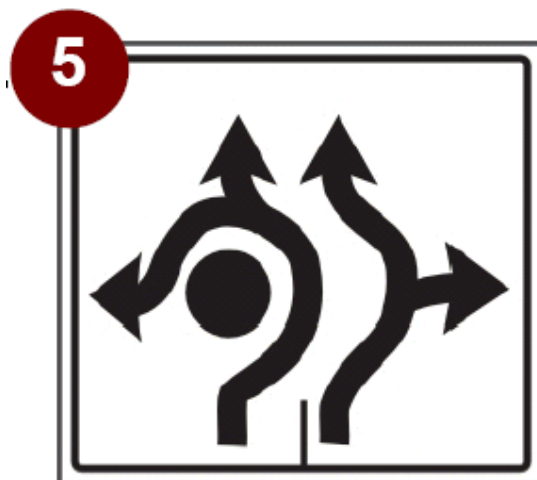
Slika 41 : Osnovna oblika vertikalne signalizacije v obliki trnka s središčnim otokom za leve zavijalce. Vir : Signing and Pavement-Marking Strategies for Multi-Lane Roundabouts, Kinzel, Urban Street Symposium 2003.
