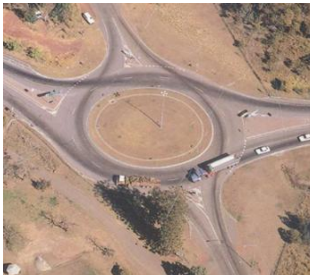
Slika 13 : Večpasovno krožno križišče v Avstraliji. Vir: Center for Transportation Research and Training.
