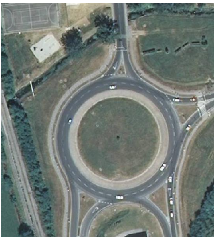
Slika 34 : Prikaz koncentričnih črt na dvopasovnem krožnem križišču Rožna dolina. Vir: Lasten vir
