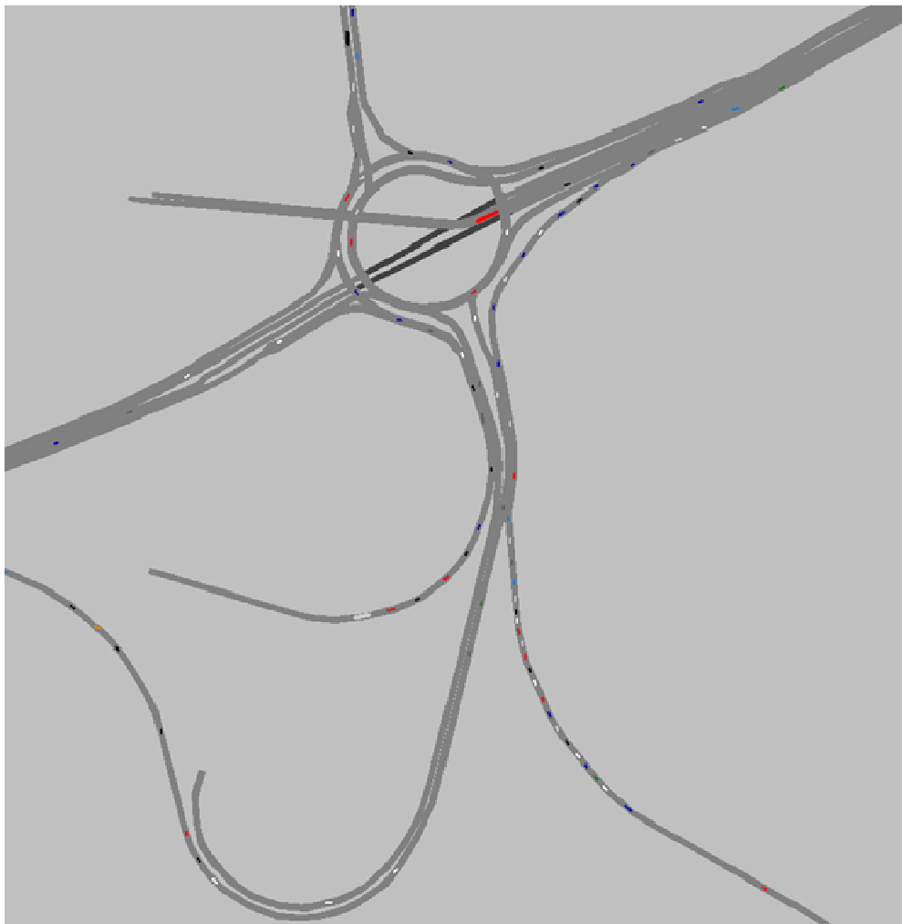
Slika 28: Prikaz simulacije spiralnega krožnega križišča z izvennivojskim vodenjem Tržaške ceste za jutranjo konico za leto 2032
