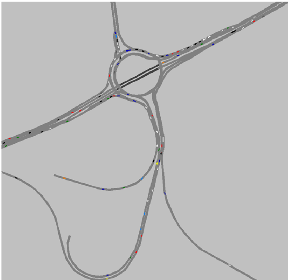
Slika 25: Prikaz simulacije spiralnega krožnega križišča z izvennivojskim vodenjem Tržaške ceste za popoldansko konico za leto 2008
