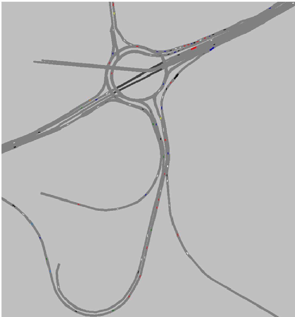
Slika 29: Prikaz simulacije spiralnega krožnega križišča z izvennivojskim vodenjem Tržaške ceste za popoldansko konico za leto 2032
