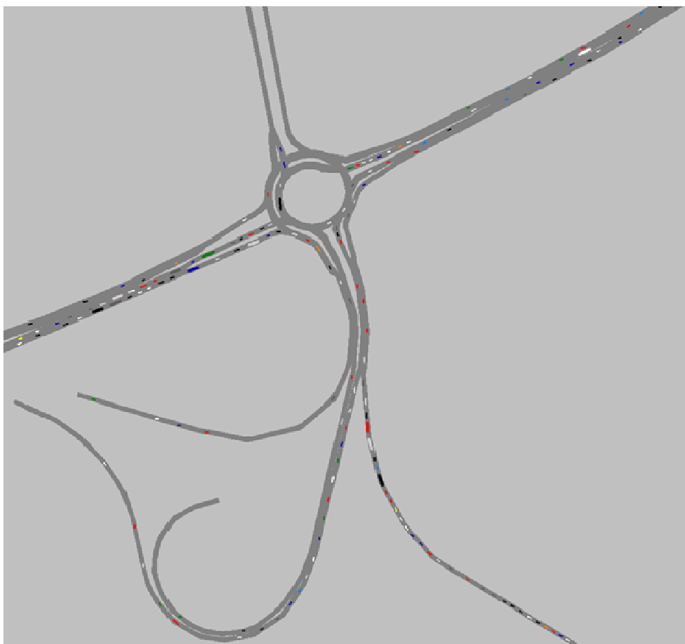
Slika 21: Prikaz simulacije spiralnega krožnega križišča za jutranjo konico za leto 2008
