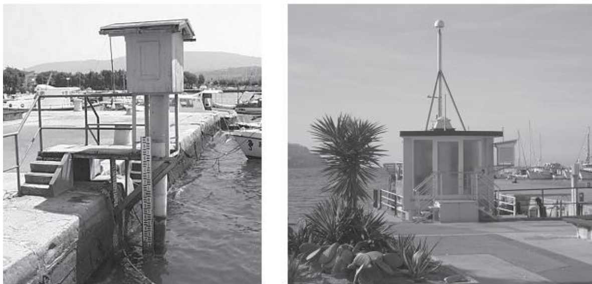
Slika 27: Stari mareograf iz leta 1958 (desno), levo pa nadgrajena mareografska postaja Koper (vir: Savšek - Safić, S. et al 2007, Terestrična izmere mikromreže pri vzpostavitvi mareografske postaje Koper, Geodetski vestnik 51/2007 – 1).
