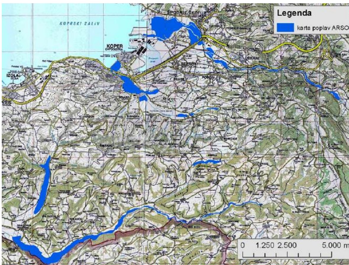
Slika 8: Opozorilna karta poplav za tri reke, ki se nahajajo na območju občine Koper: Rižana, Badaševica in Dragonja (vir: Inštitut za vode Republike Slovenije, 2007).
