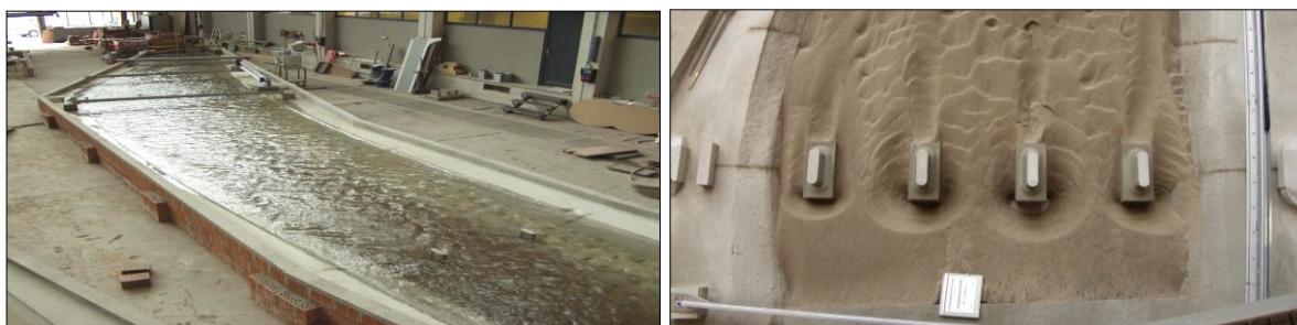
Slika 13: Fizični model (levo) in prikaz rezultatov – erozije (desno) (vir: Steinman, F., Banovec, P. 2008. Hidrotehnika, Vodne zgradbe I, učno gradivo).
