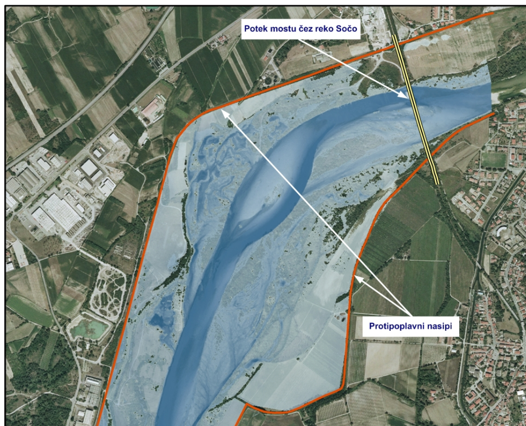
Slika 33: Prikaz poplavljanja reke Soče pri pretoku 2500\text{m}^3/\text{s} . Jasno se vidi kako protipoplavni nasipi predvsem na desnem bregu ščitijo industrijski obrat pred preplavitvijo.
