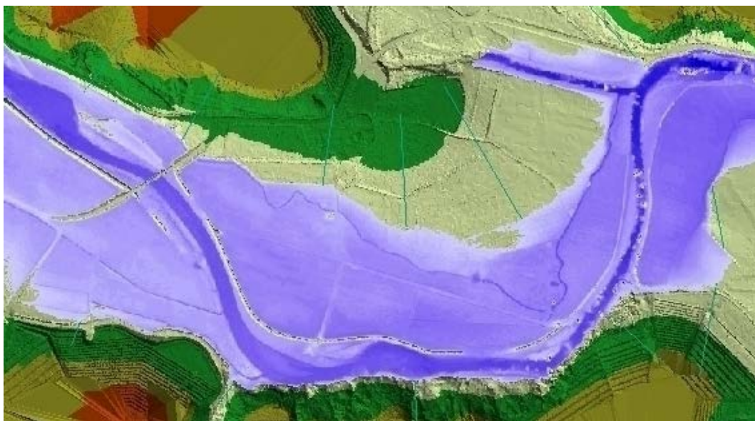
Slika 10: Prikaz kartiranja poplavnih površin reke Soče pri pretoku 2000 m 3 /s na digitalnem modelu terena.
