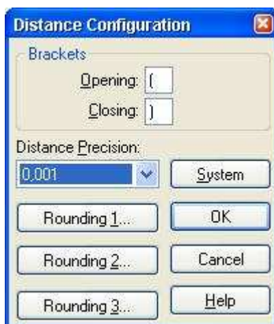
Slika 39: LEICA GEOSYSTEMS LISCAD S.E.E. - Dolžinske nastavitve
