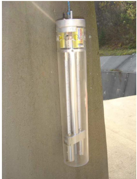
Slika 7: Psihrometer MICRONEL® AG na točki P3, Moste 2006
