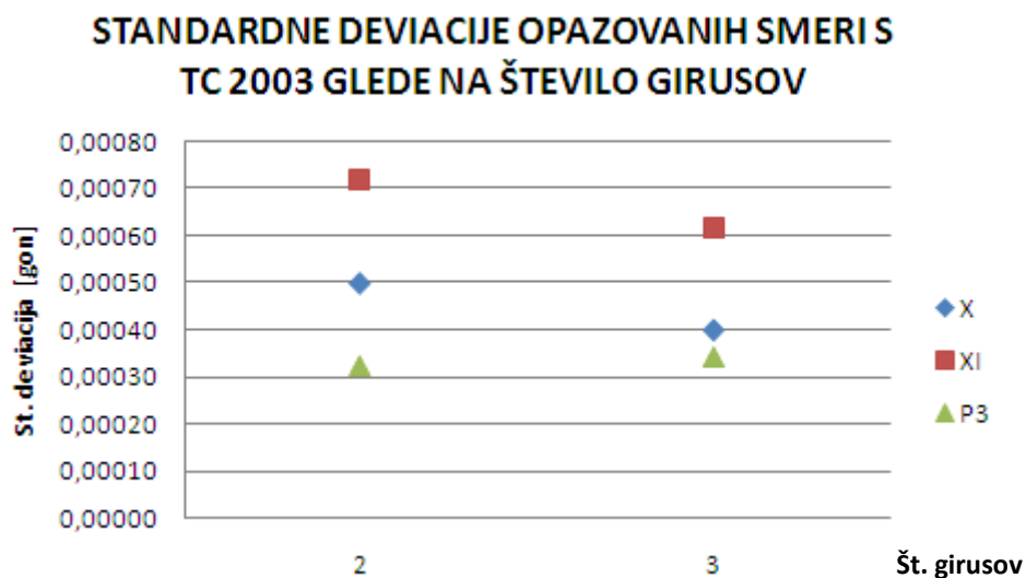
Grafikon 1: Standardne deviacije opazovanih smeri z instrumentom LEICA GEOSYSTEMS TC2003 glede na število girusov
