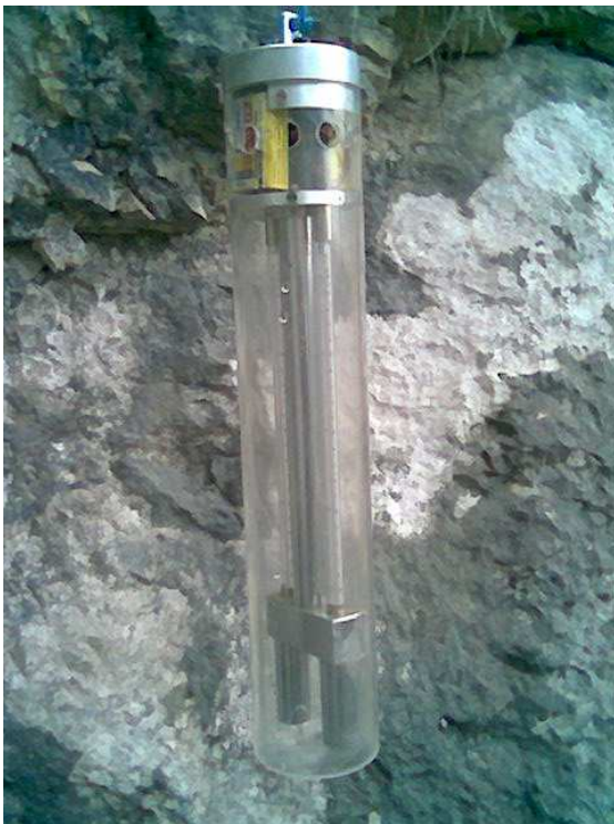
Slika 6: Psihrometer MICRONEL® AG v bližini točke X, Moste 2006
