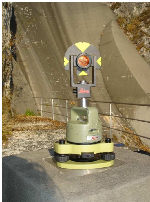
Slika 15: Signalizacija točke XI: Reflektor LEICA Mini Prism GMP101, Moste 2006
