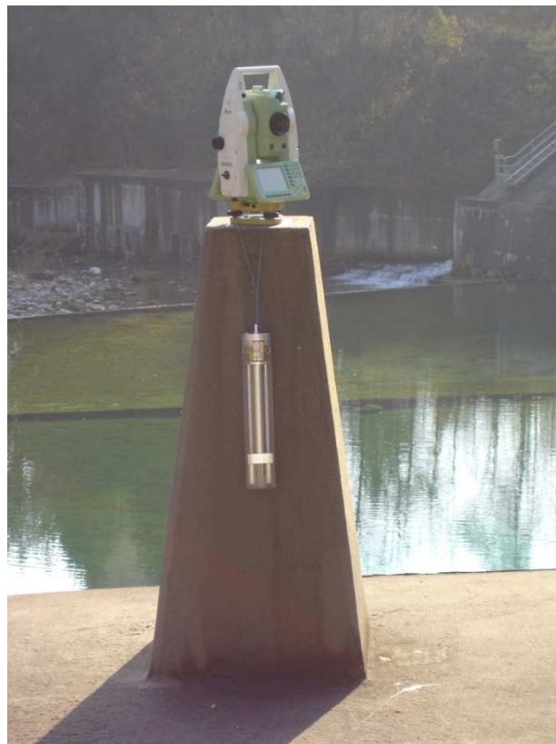
Slika 11: Betonski steber, s katerim je stabilizirana točka P3 na pregradi, Moste 2006
