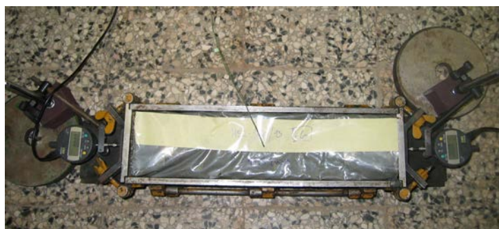
Slika 4.4: Elektronsko merjenje avtogenega krčenja kompozita oziroma betona Figure 4.4: Electronic measure of autogenous shrinkage of composite or concrete
