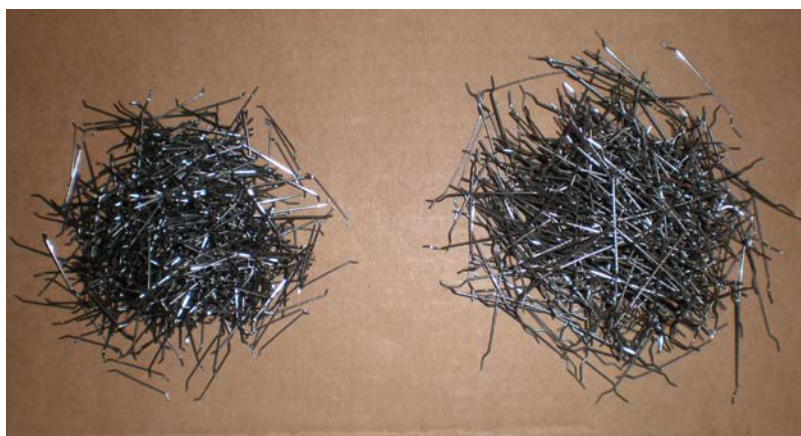
Slika 4.1: Uporabljena jeklena vlakna (levo IRI 50/16 (VJ1) in desno IRI 50/30 (VJ2))
