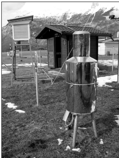
Slika 3.22: Dežemer OTT Pluvio na meteorološki postaji Bovec (foto: Sašo Petan).
