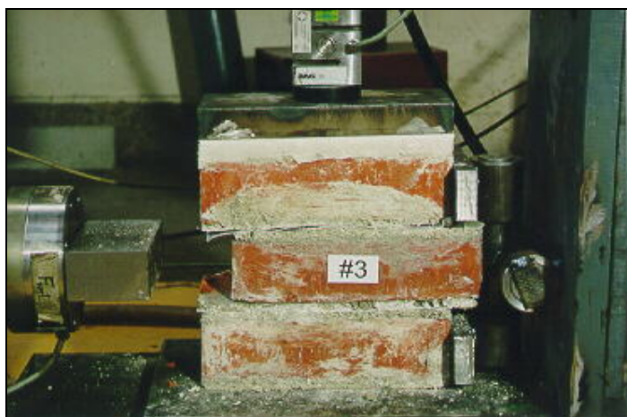
Slika 171: Porušitev vzorca št. 3 pri največji hitrosti drsenja 250 mm/s – kombiniran zdrs Fig. 171: Mode of failure for specimen number 3 at sliding velocity of 250 mm/s – combined slip
