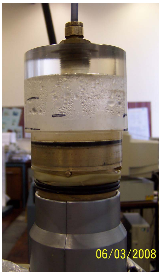
Slika 3.17: Sukcijska kapa za pospešitev procesa saturacije Figure 3.17: Suction cap to speed up the saturation process
