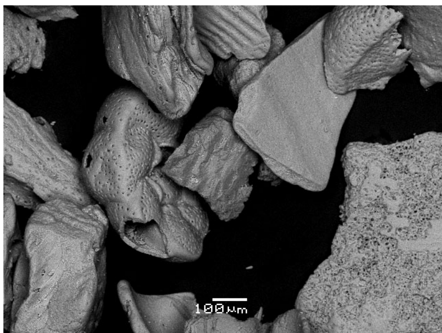
Slika 4.6: Fotografija zrn peska Dogs Bay z vrstičnim elektronskim mikroskopom pri povečavi \times 130 (foto A. Mladenovič)
