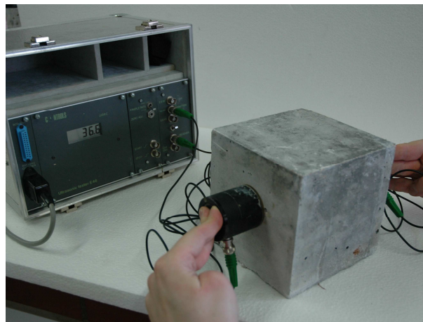
Slika 3.12 a) Določanje sklerometričnega indeksa, betonski vzorec dimenzij 150 \times 150 \times 150 mm, b) določanje hitrosti prehoda vzdolžnih ultrazvočnih valov skozi betonski vzorec dimenzij 150 \times 150 \times 150 mm.
