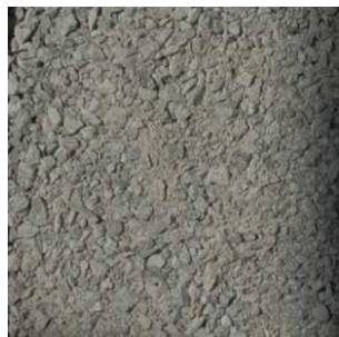
Slika 5.1 Drobljeni agregat apnenčevega izvora, a) frakcija 0 – 4 mm, b) frakcija 4-8 mm, c) frakcija 8 – 16 mm, d) frakcija 16 – 32 mm.
