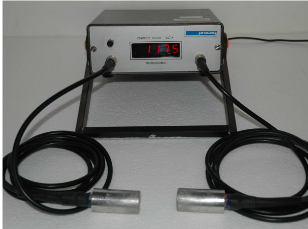
Slika 3.1 Inštrumenta za kontinuirno merjenje hitrosti prehoda vzdolžnega ultrazvočnega valovanja skozi preskušance, a) inštrument Proceq, b) inštrument Pundit.
