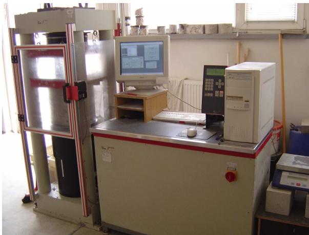
Slika 3.11 Preiskava tlačne trdnosti betona po standardu SIST EN 12390-3:2002, a) naprava za destruktivno preiskavo tlačne trdnosti, b) značilna porušitev betonskega vzorca.
