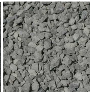
Slika 5.1 Drobljeni agregat apnenčevega izvora, a) frakcija 0 – 4 mm, b) frakcija 4-8 mm, c) frakcija 8 – 16 mm, d) frakcija 16 – 32 mm.
