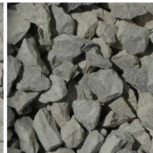
Slika 5.1 Drobljeni agregat apnenčevega izvora, a) frakcija 0 – 4 mm, b) frakcija 4-8 mm, c) frakcija 8 – 16 mm, d) frakcija 16 – 32 mm.
