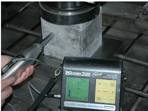
Slika 3.12 a) Določanje sklerometričnega indeksa, betonski vzorec dimenzij 150 \times 150 \times 150 mm, b) določanje hitrosti prehoda vzdolžnih ultrazvočnih valov skozi betonski vzorec dimenzij 150 \times 150 \times 150 mm.
