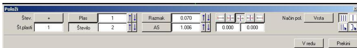
Slika 47: definiranje parametrov polaganja armature
