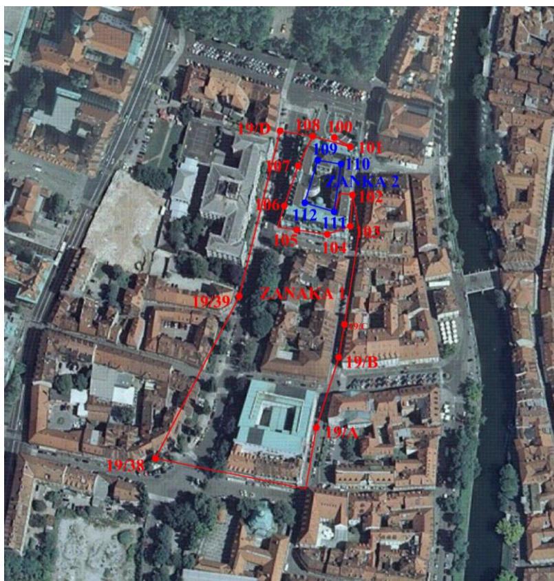
Slika 3: Nivelmanska mreža za določevanje vertikalnih premikov
