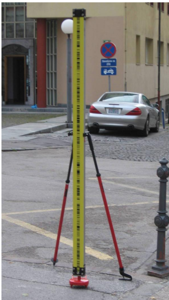
Slika 20: Nivelmanska lata GPCL2, stojalo in podložka (»žaba«)
