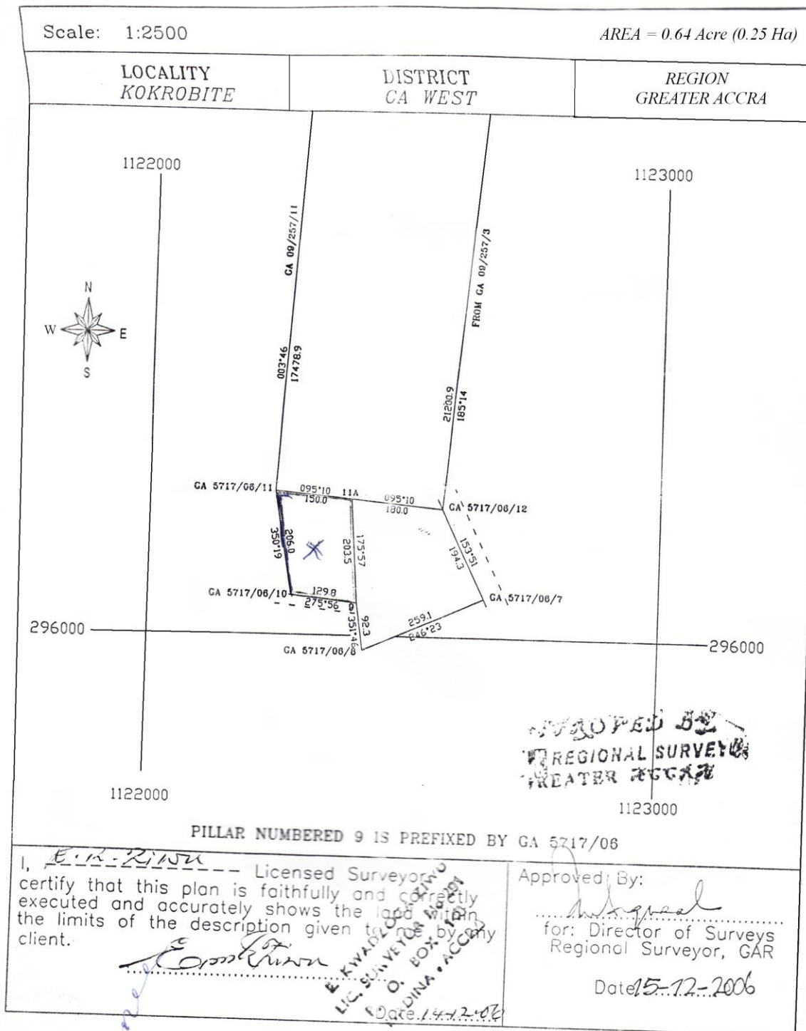
Slika 23: Skica katastrske izmere v Gani (Vprašalnik o primeru odmere in nakupa zemljišča v Gani.
