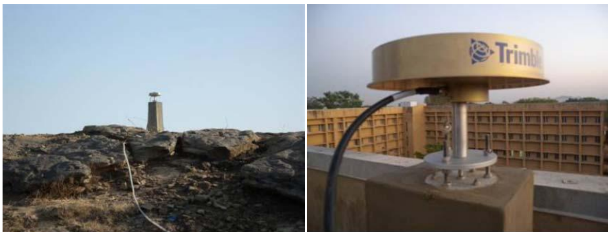
Sliki 5 in 6: Postavitev stalnih baznih postaj GNSS – pomen stabilnosti stojišča (Jatau, 2010).
