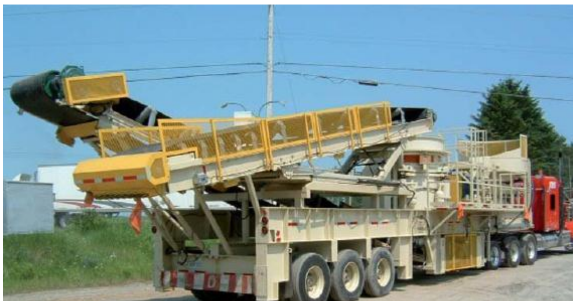
Slika 16: Mobilni udarni drobilec z magnetnim odstranjevanjem (Nordberg) [33]
