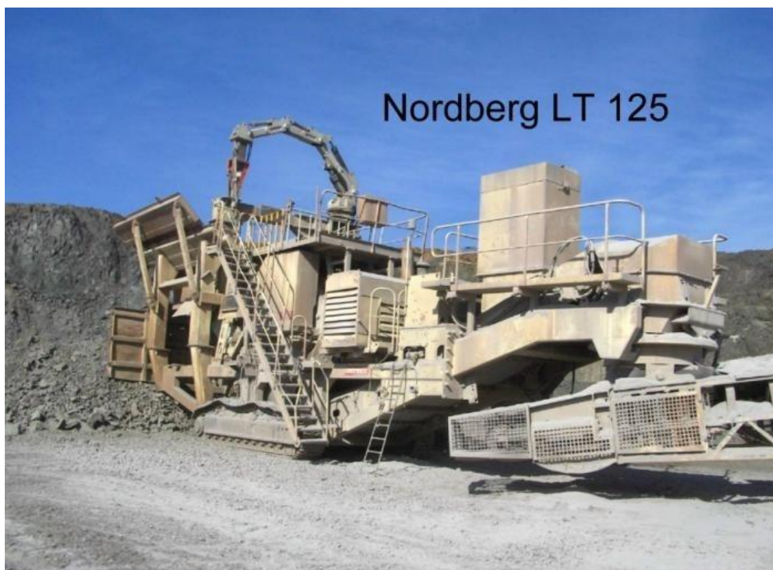
Slika 17: Mobilni kombinirani drobilec in sejalne naprave (Nordberg) [33]
