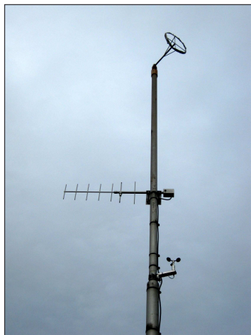
Slika 3: Merilno mesto sistema Burja z merilnikom – vetrovnico za merjenje sunkov vetra
