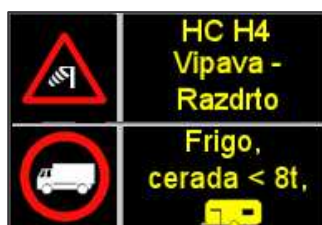
Slika 30: Primer prometne vsebine na SPISpp prikazovalniku v sistemu SNVP (prikaz posamezne vsebine utripa na dve sekundi)
