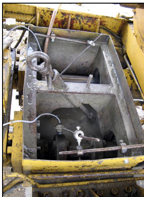
Slika 3.9: Merjenje porabe betona s pomočjo batne črpalke
