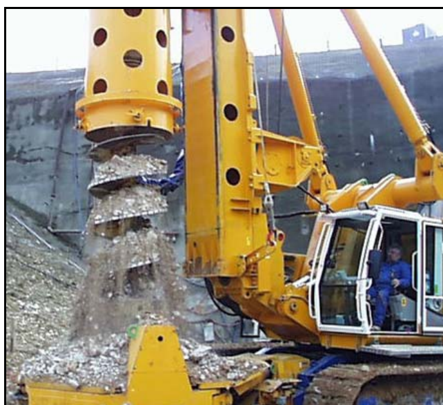
Slika 2.5: Postopek odstranjevanja zemljine s svedra
