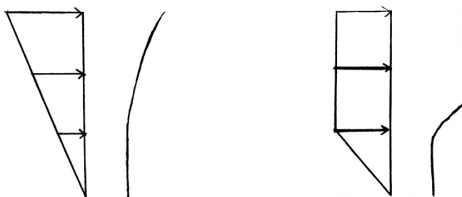
Slika 68: Pretežna porušna mehanizma zaradi različnih razporeditev horizontalnih sil
