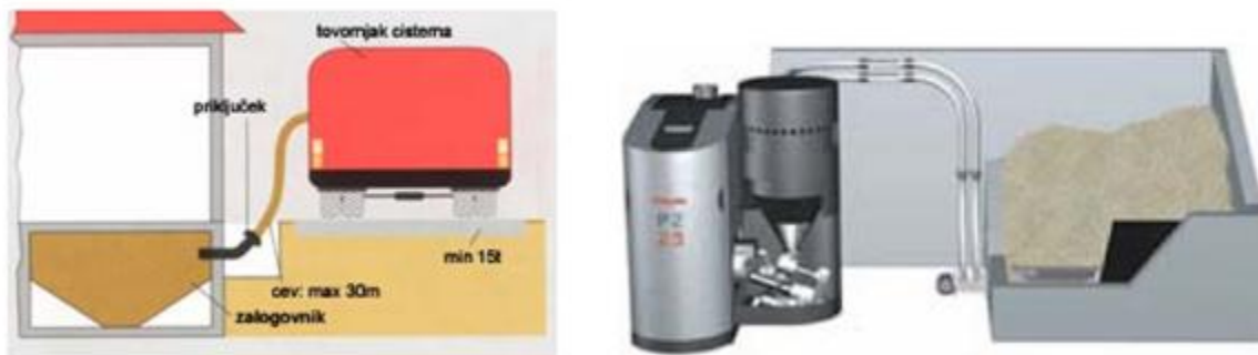
Slika 9: Primer dovajanja peletov v zalogovnik in od zalogovnika do peči, podajanje s sesanjem (AURE)
