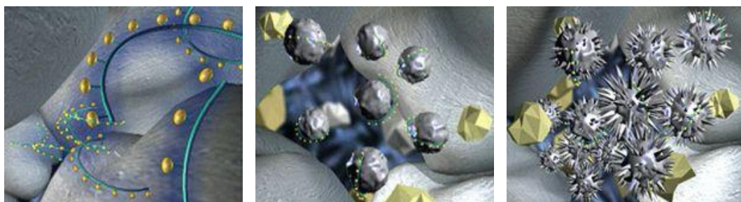
Slika 25: Shematični prikaz delovanja običajnega superplastifikatorja [2]
