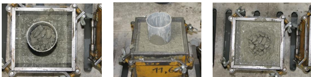
Slika 79: Priprava grobozrnatih gnezd v naših preskušancih
