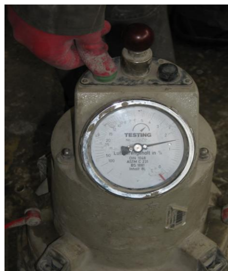
Slika 37: Prozimeter SIST EN 12350-7
