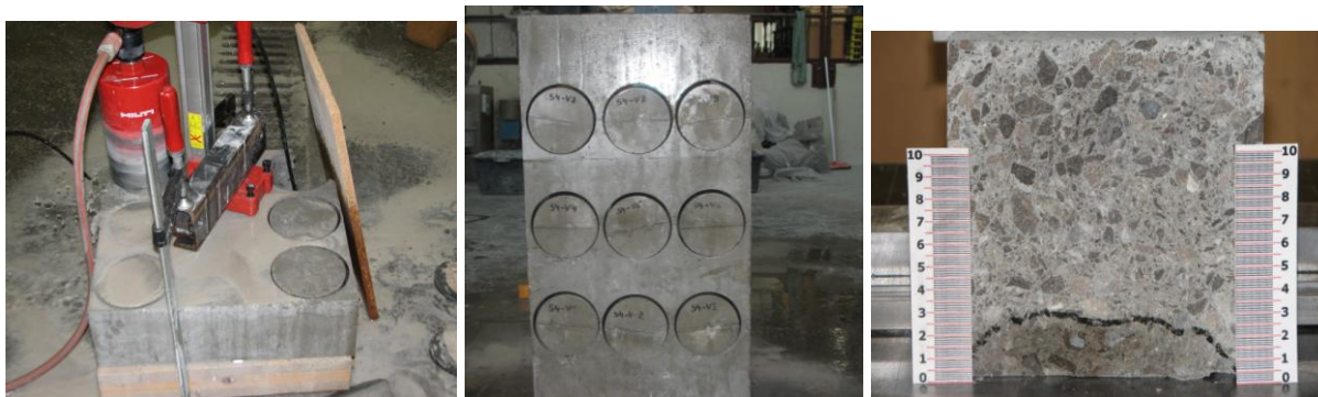
Slika 81: Prikaz priprave preskušancev za preskus vodotesnosti betona po hladnem stiku
