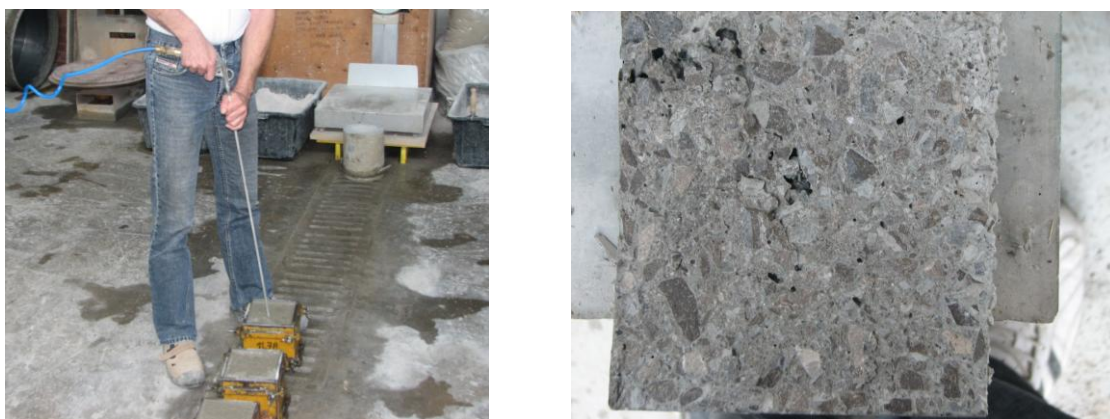
Slika 83: Prikaz dovajanja zraka preskušancu pod pritiskom in por v notranjosti preskušanca
