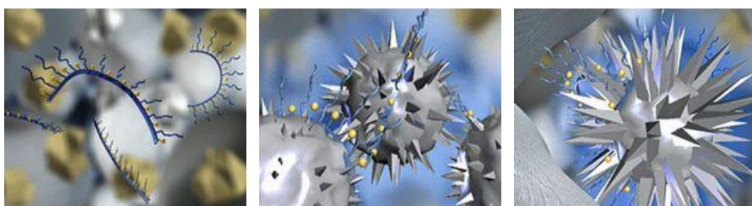
Slika 26: Shematični prikaz delovanja superplastifikatorja nove generacije [2]
