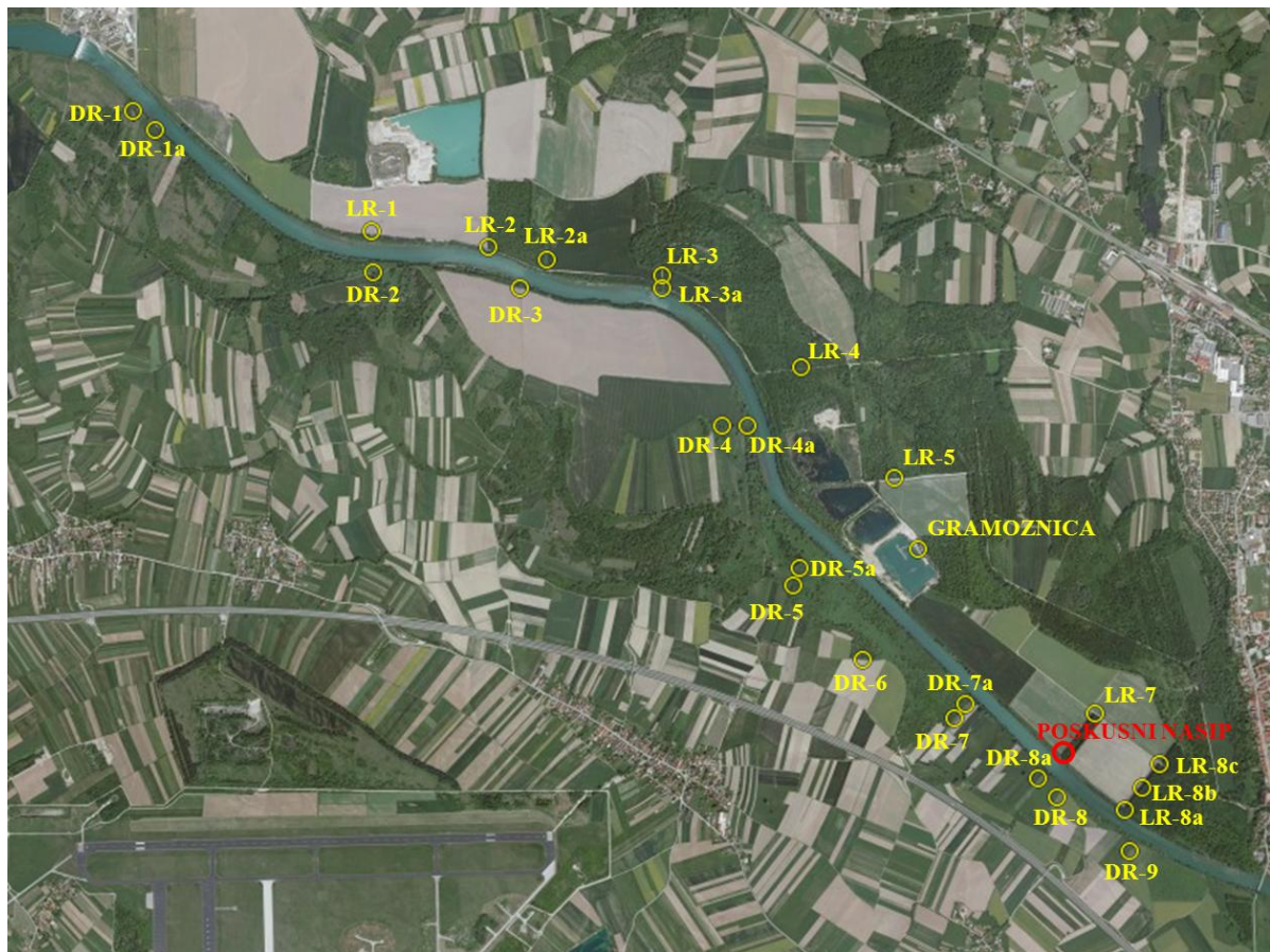
Slika 5.2: Lokacije opravljenih razkopov in poskusnega nasipa.
