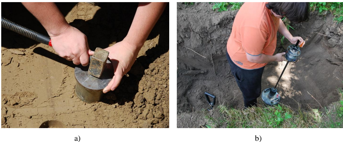
Slika 5.1: Raziskovalni jaški: a) intaktno vzorčenje v raziskovalnem jašku, b) poskus ugotavljanja togosti naravnih plasti s krožno ploščo.
