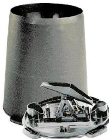
Slika 3: Instrumenti za merjenje padavin: a) totalizator, b) avtomatski dežemer (Brilly in Šraj, 2006)
