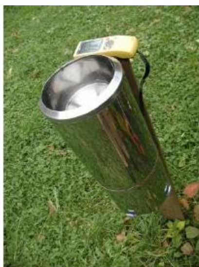
Slika 3: Instrumenti za merjenje padavin: a) totalizator, b) avtomatski dežemer (Brilly in Šraj, 2006)
