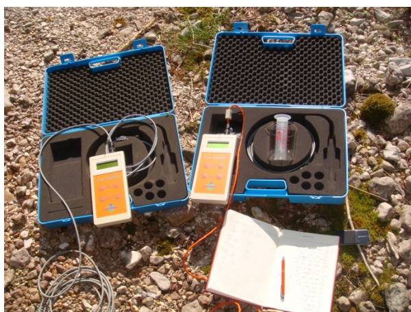
Slika 11: Inštrument Flo-Tracer za meritve pretokov s kemijsko integracijsko metodo s trenutnim vnosom soli
