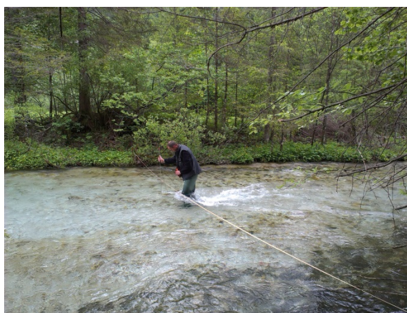
Slika 12: Meritve pretokov s hidrometričnim krilom na lokaciji Klemenak
