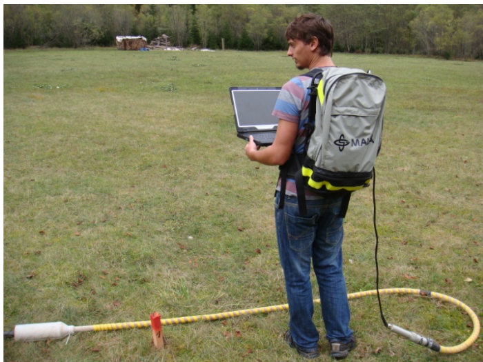
Slika 29: Zakoličeni georadarski profil in georadarska oprema
