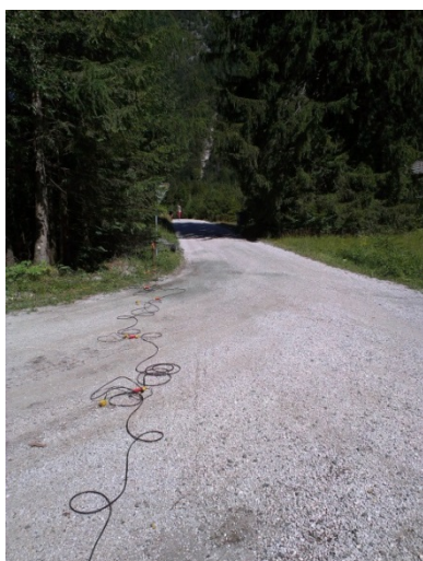
Slika 31: Postavitev 40-Hz geofonov
