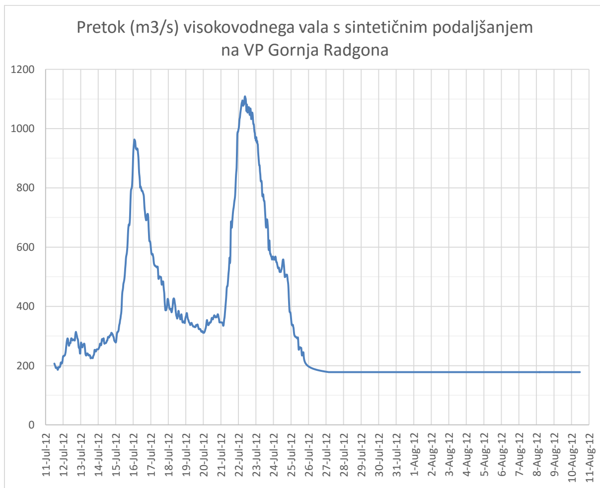
Grafikon 9: Zgornji robni pogoj za račun nestalnega toka, pretoki na VP Gornja Radgona med 11. in 25.7.2012 (ARSO) s sintetičnimi dodanimi 15 dnevi stalnega toka
