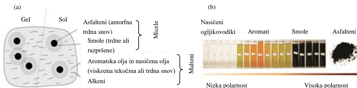
Slika 6: (a) Splošni model sestave bitumna [27] in (b) SARA skupine bitumna [28]
