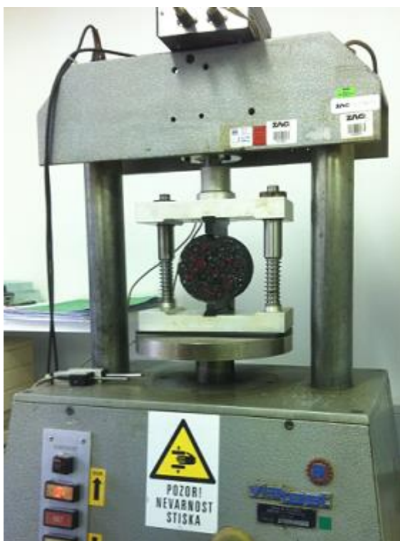
Slika 41: Naprava za določanje neposredne natezne trdnosti
