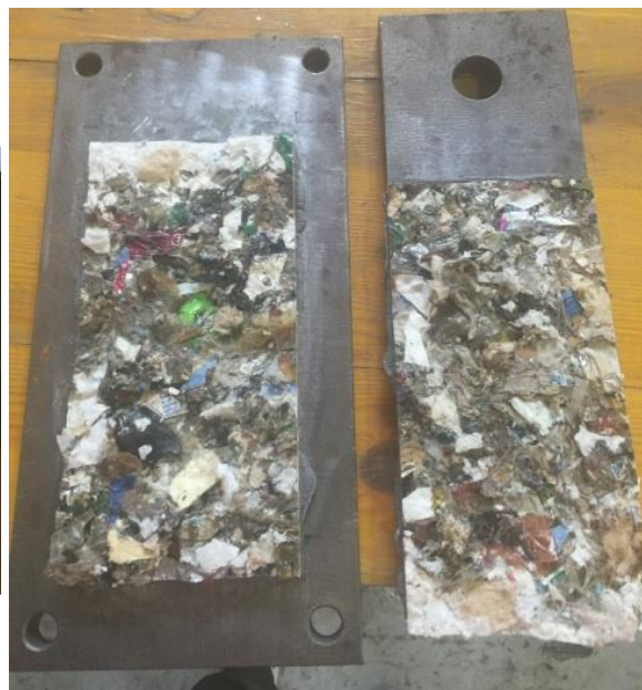
Slika 52: Strig po plasti – vzorec P10 po preiskavi
