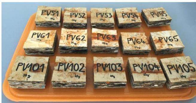
Slika 40: Nabrekli vzorci po petih dnevih v vodi
