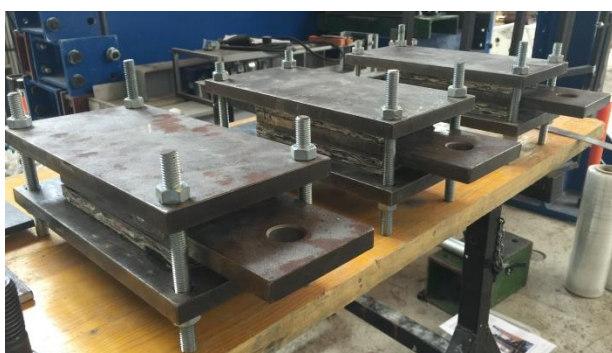
Slika 32: Pripravljeni vzorci za strižni test – po dve plošči sta prilepljeni na sistem treh vzporednih togih jeklenih plošč
