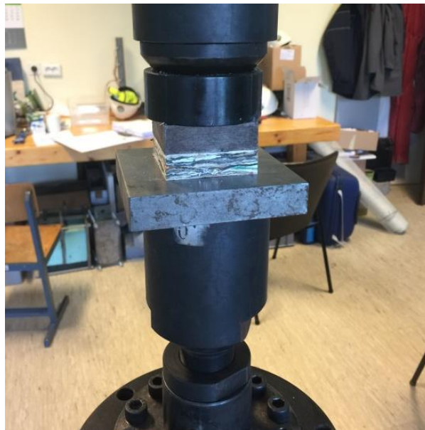
Slika 26: Detajl izvedbe tlačnega testa
