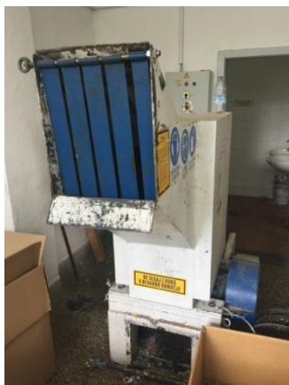
Slika 9: Naprava za mletje odpadne embalaže (šreder)
