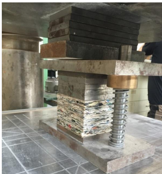
Slika 27: Oblika preizkušancev in postavitev v hidravlično stiskalnico kapacitete 5.000 kN
