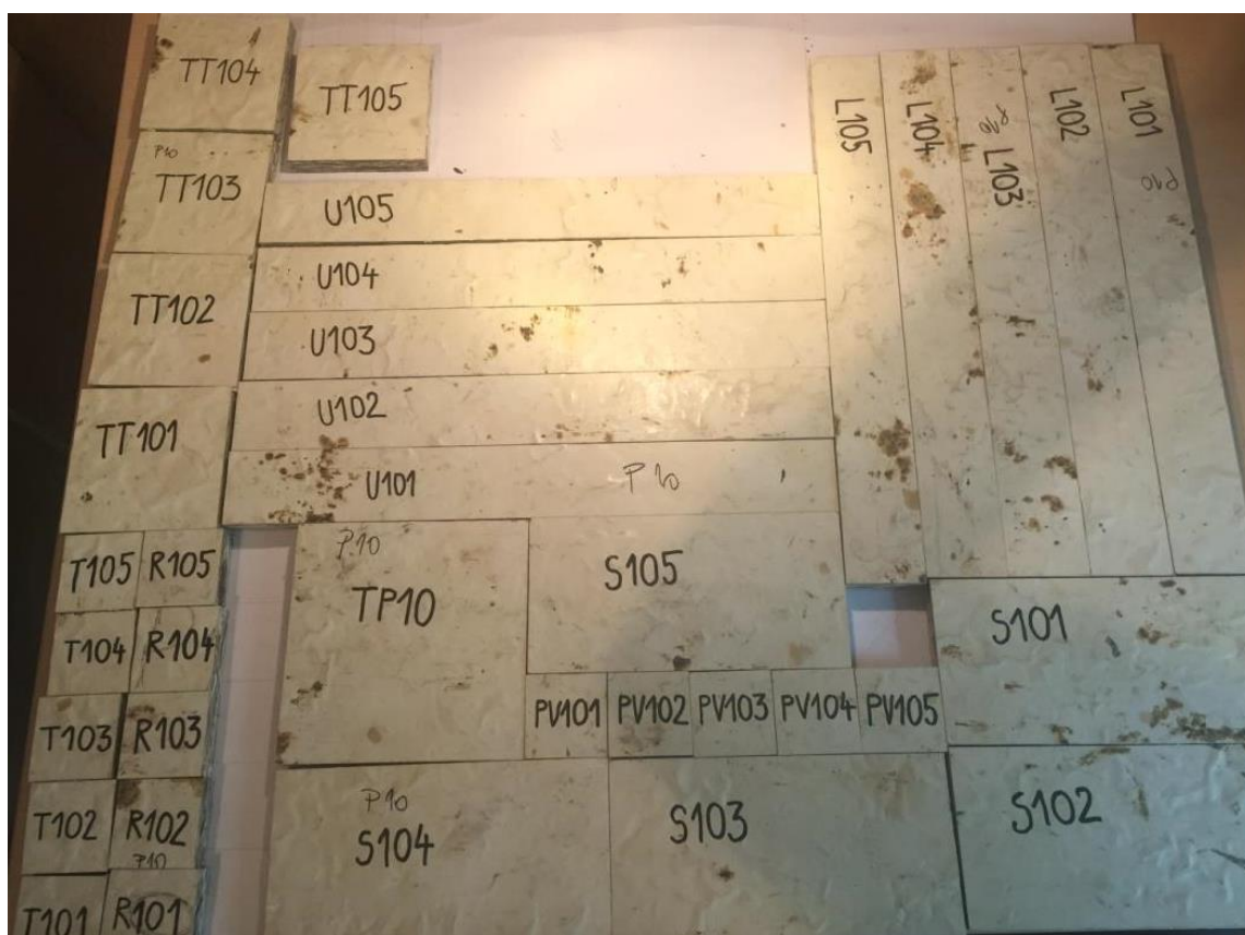
Slika 25: Prikaz izrezanih in označenih standardnih preizkušancev plošče P10
