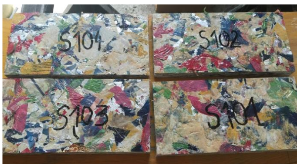
Slika 30: Oblika preizkušancev za strižne preiskave po standardu SIST EN 12090:2013
