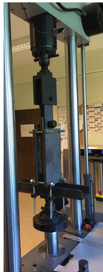
Slika 33: Izvedba strižnega testa po standardu SIST EN 12090:2013 v servo-hidravličnem stroju
