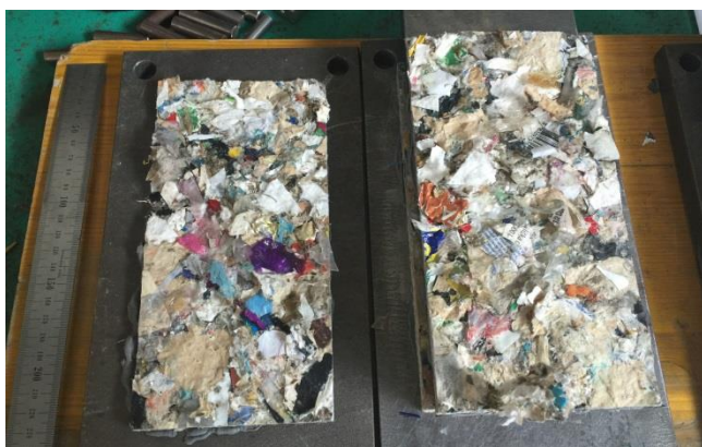
Slika 51: Strig po plasti – vzorec P6 po preiskavi
