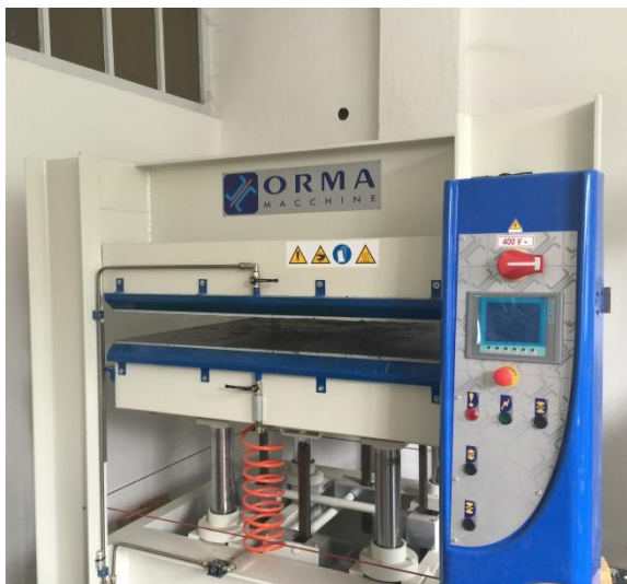
Slika 11: Naprava za stiskanje plošč
