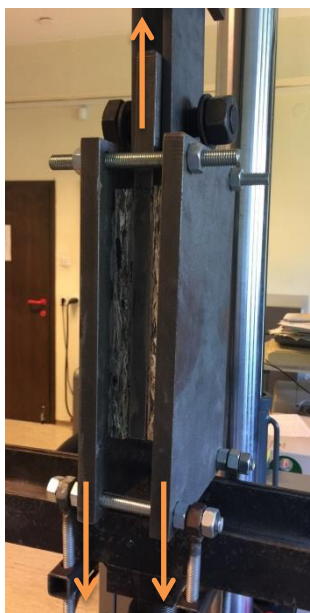
Slika 34: Vpet vzorec, pripravljen za strižni test z oznakami delovanja sil
