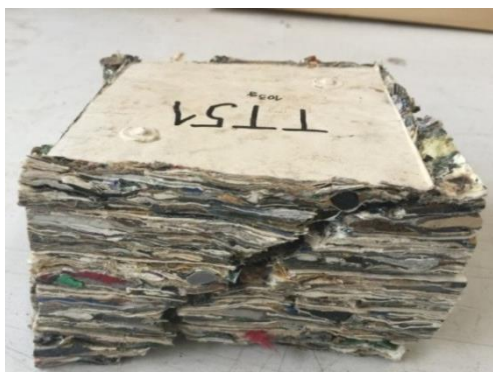
Slika 49: Porušna oblika preizkušanca plošče P5
