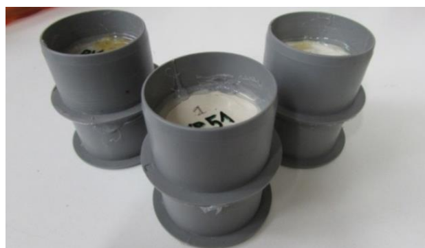
Slika 48: Zatesnjeni vzorci nad posebno oblikovano čašo, pripravljeni za analizo (Foto: dr. Andreja Padovnik)
