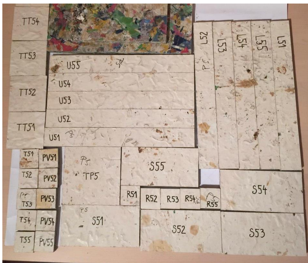
Slika 23: Prikaz izrezanih in označenih standardnih preizkušancev plošče P5
