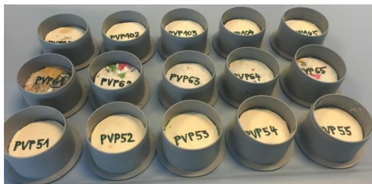
Slika 46: Oblika preizkušancev (diski) za preiskavo prepustnosti za vodno paro
