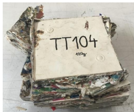
Slika 50: Porušna oblika preizkušanca plošče P10
