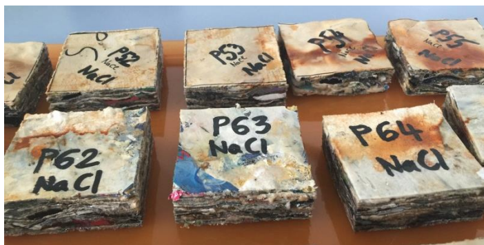
Slika 44: Vzorci po odležavanju v raztopini NaCl po 24 urah
