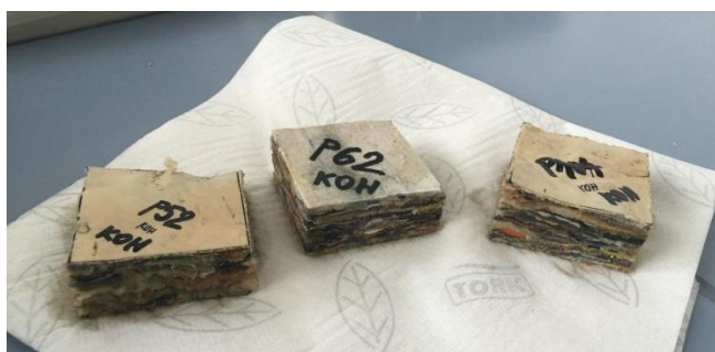
Slika 42: Vzorcevi po odležavanju v raztopini KOH po 24 urah
