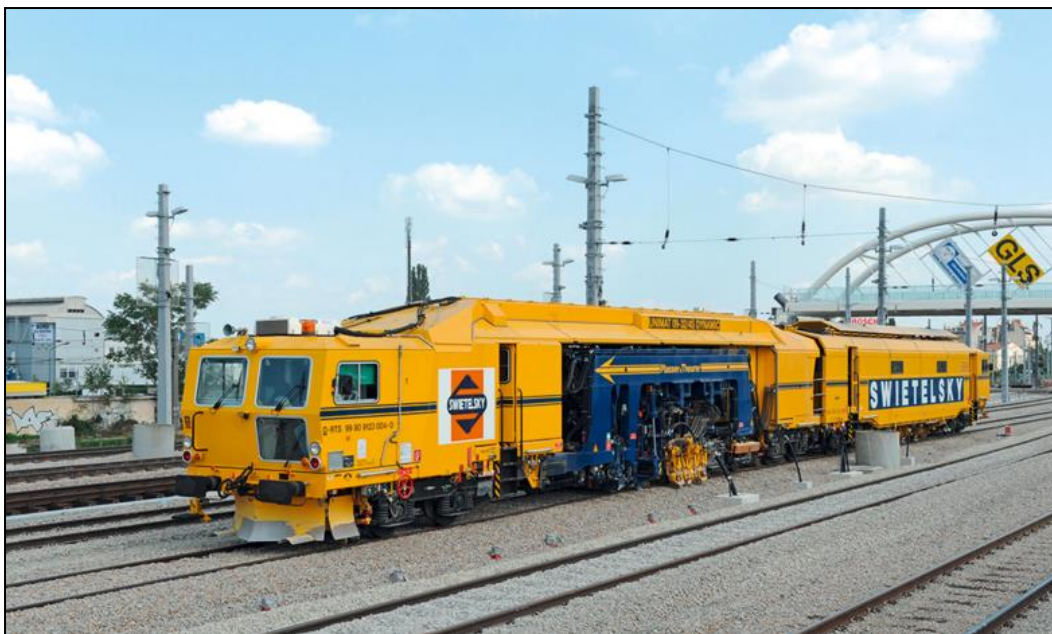
Slika 37: Delovni stroj Unimat 09-32/4S za regulacijo tira z uporabo dinamične stabilizacije tira (Hochleistung Präzision Zuverlässigkeit, 2016)
