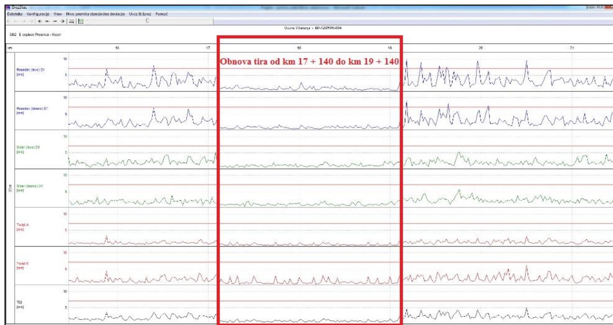
Slika 34: Primerjava med obnovljenim in neobnovljenim tirom na železniški progi cepišče Prešnica–Koper potniška (Program DrezStac, 2016)
