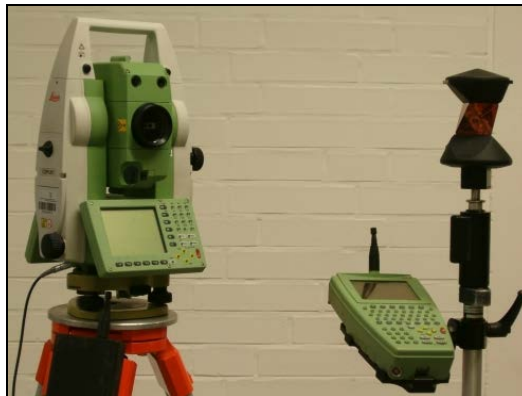
Slika 12: Elektronski tahimeter Leica TCRP1201 R300
