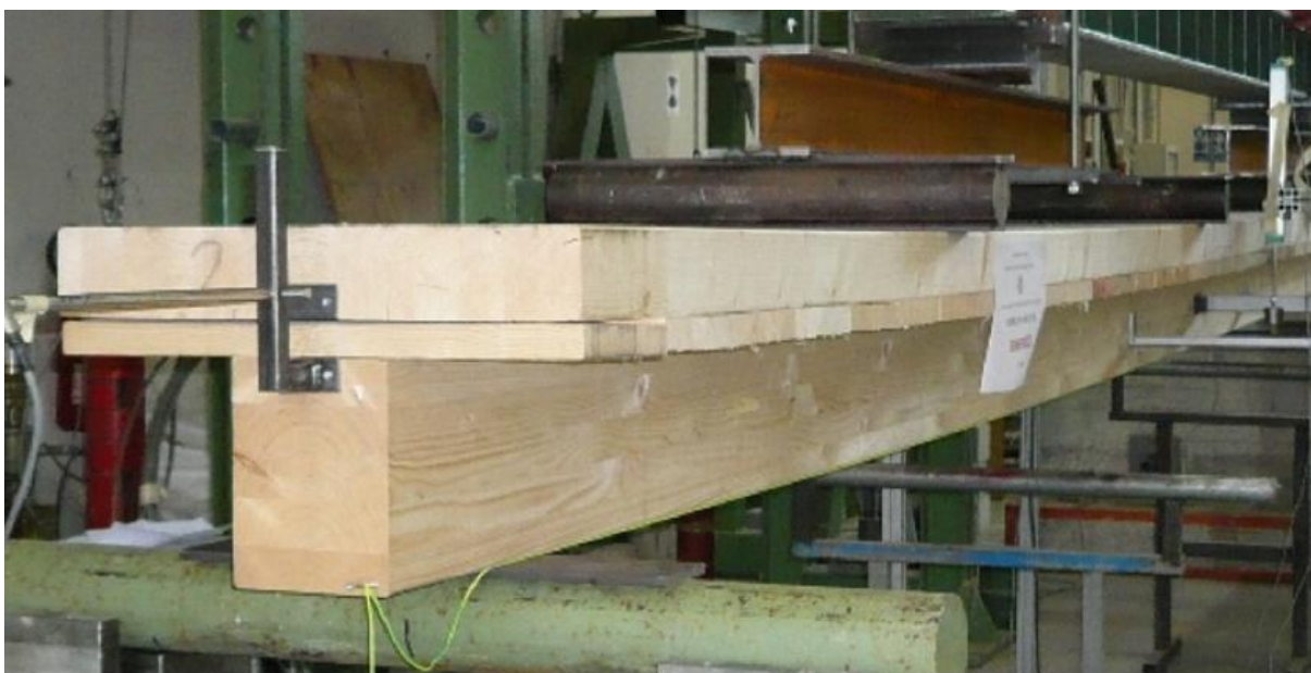
Slika 18: Primer lesenega sovprežnega nosilca v kombinaciji z jeklom (Dicam)
