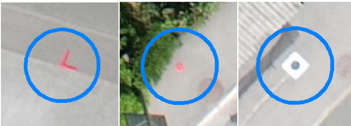
Slika 6.5: Signaliziranje jeklenih klinov: s sprejem označeni dve črti (levo) in krog (sredina) na asfaltu ter označba s tarčo (desno); (ortofoto: Modri planet d. o. o.).
