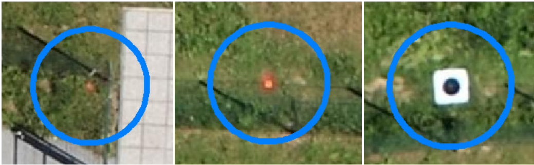
Slika 6.4: Signaliziranje plastičnih mejnikov: s sprejem označena kapa mejnika (levo) in okolica mejnika (sredina) ter označba s tarčo (desno) (ortofoto: Modri planet d. o. o.).
