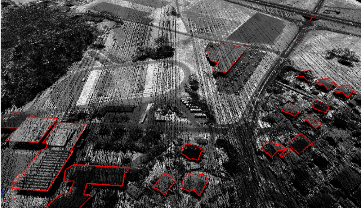
Slika 6.12: Oblak točk državnega aerolaserskega skeniranja LSS z ločljivostjo 5 točk/m 2 (Geodetska uprava Republike Slovenije).
