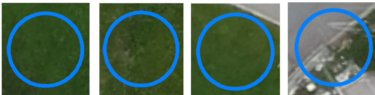
Slika 6.8: Zajem nesignaliziranih plastičnih mejnikov na travi in betonskega mejnika (desno) (ortofoto: Geavis d. o. o.).
