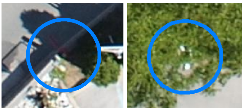
Slika 6.6: Primera slabe vidljivosti točk pri betonskem mejniku zaradi sence (levo) in pri tarči zaradi drevesne krošnje (desno) (ortofoto: Modri planet d. o. o.).
