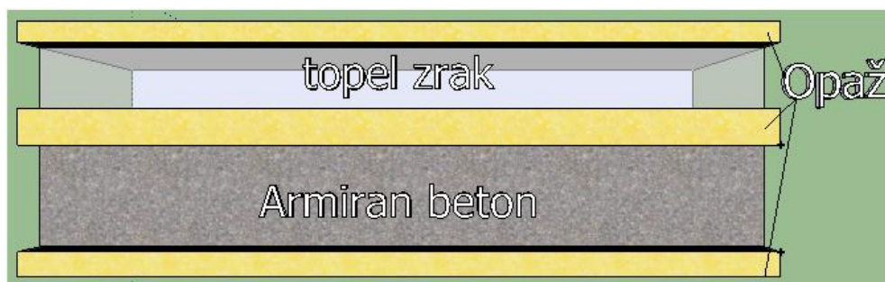
Slika 33: Primer dvojnega opaža s segrevanjem betona s toplim zrakom
