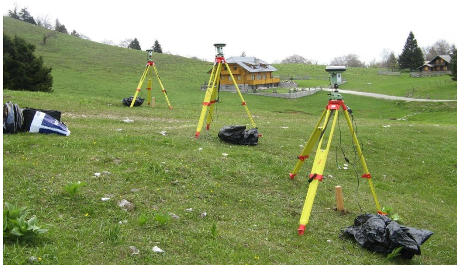
Slika 18: Postavitev sprejemnikov na merjenih točkah
