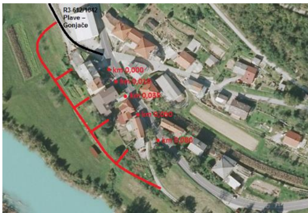
Slika 4.29: Idejna rešitev priključkov v km 0,010, km 0,035, km 0,060 in km 0,080 [14]
