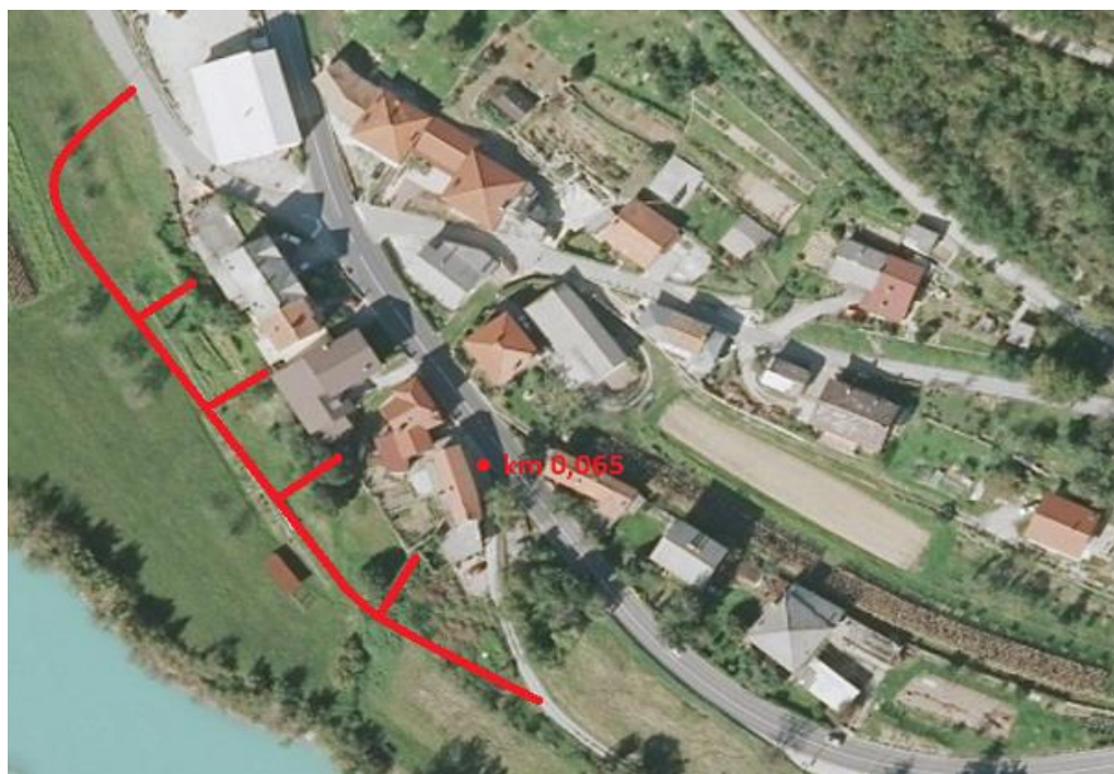
Slika 4.32: Idejna rešitev priključka v km 0,065, pogled v smeri stacionaže [14]
