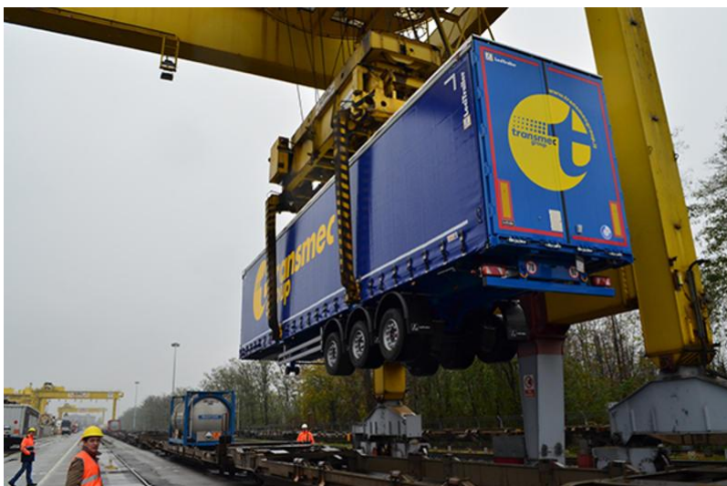
Slika 21: Nalaganje polprikolice na vagon (Lanari, 2016)
