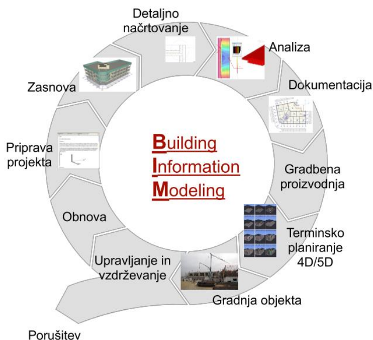
Slika 2: življenjski cikel gradbenega objekta
