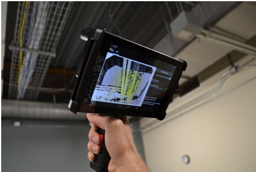
Slika 8: Ročni skener kratkega oz. srednjega dosega (Vir: Trimble)
