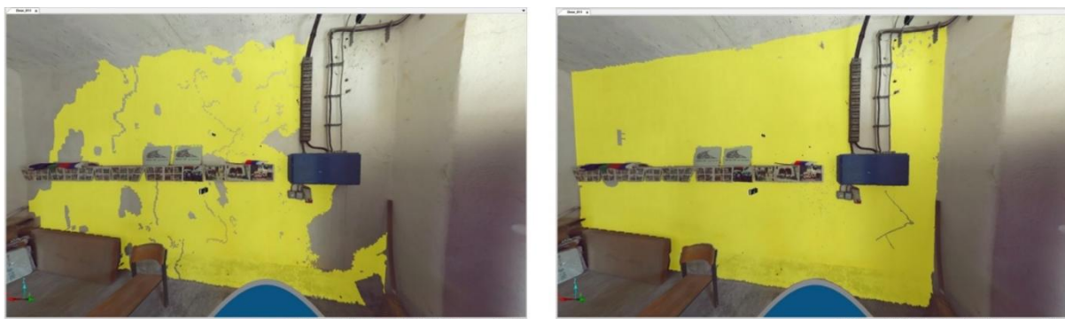
Slika 40: Prva stena: levo maksimalno odstopanje 3 mm, desno 8 mm
