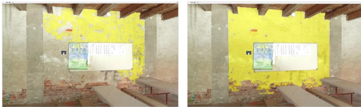
Slika 41: Druga stena: levo maksimalno odstopanje 3 mm, desno 8 mm
