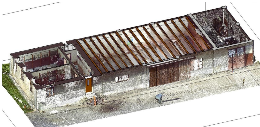
Slika 38: Iz slike je razvidno, da površina, ki jo določa oblak točk ne nalega popolnoma na model.
