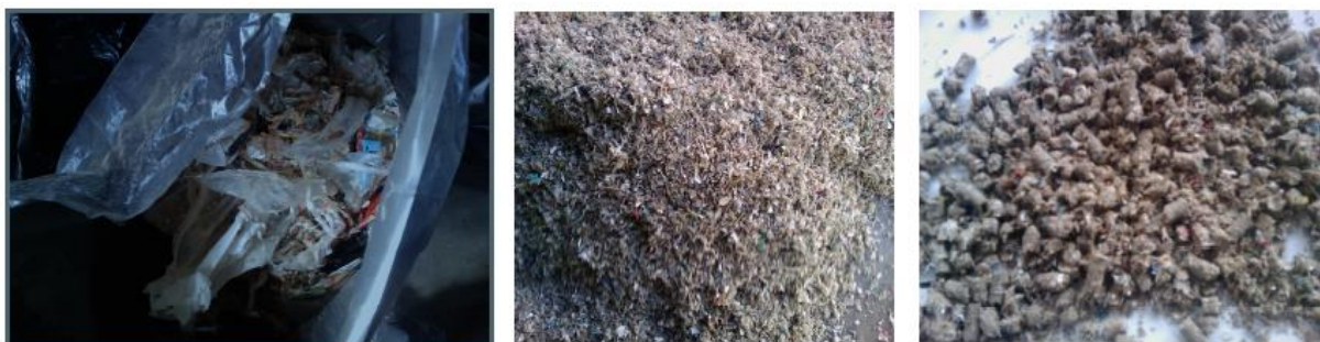
Slika 17: Predelava mešanih komunalnih odpadkov: vhodni material je lahka frakcija mešanih komunalnih odpadkov (levo), izhodni material so plastični peleti (desno) (Vir: osebni.)
