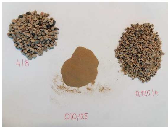
Slika 24: Vzorec po frakcijah
