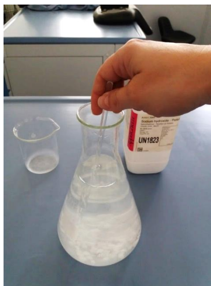
Slika 46: Priprava raztopine NaOH
