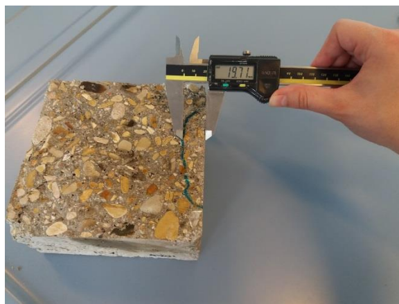
Slika 79: Meritev globine vode
