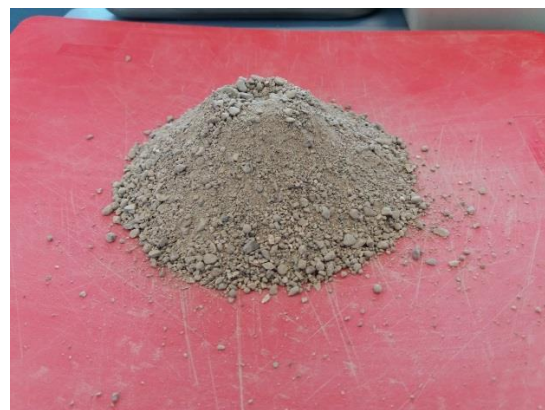
Slika 44: Nasičen, površinsko suh agregat
