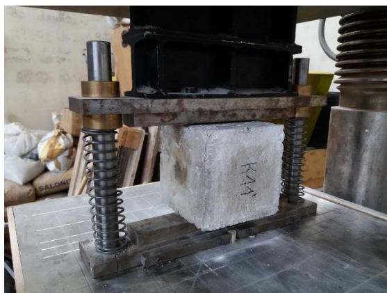
Slika 75: Preskušanelec v stiskalnici
