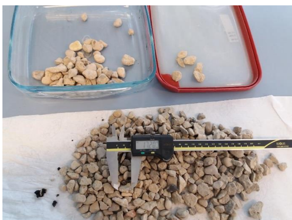
Slika 28: Ločevanje zrn glede na obliko
