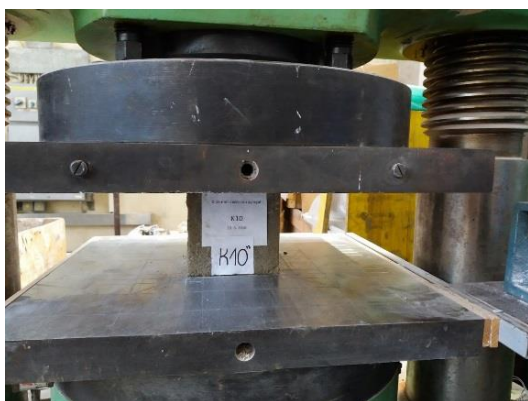
Slika 71: Preskušanje tlačne trdnosti
