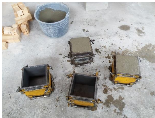
Slika 59: Napolnjena kalupa s svežim betonom
