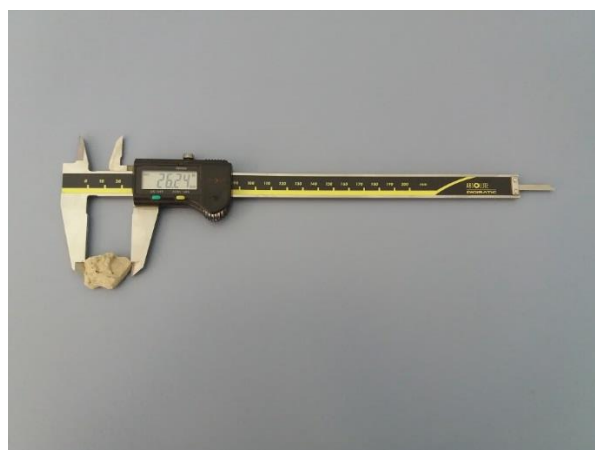
Slika 26: Merjenje s kljunastim merilom
