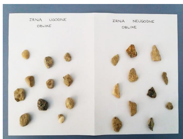
Slika 29: Zrna ugodne (levo) in neugodne (desno) oblike
