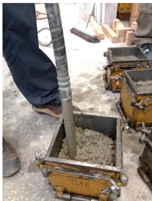
Slika 58: Zgoščevanje svežega betona
