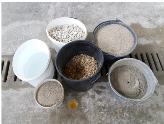
Slika 47: Natehtane sestavine za pripravo betona
