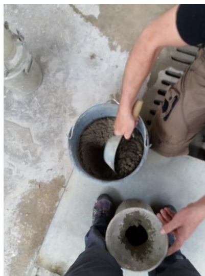
Slika 54: Polnjenje kalupa s pomočjo lijaka
