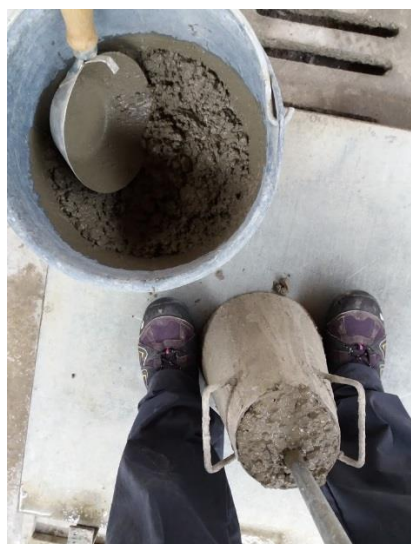
Slika 55: Zgoščevanje s kovinsko palico
