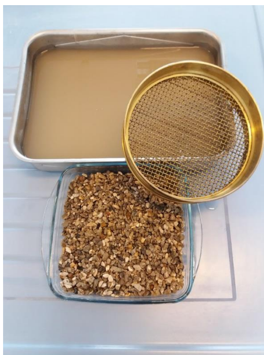
Slika 20: Pranje vzorca in shranjevanje odpadne vode
