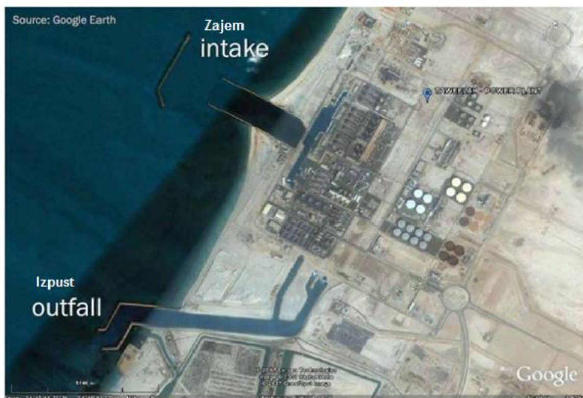
Slika 16: Satelitska slika zajema in izpusta Taweelah MSF naprave s kapaciteto 1,12 mio m 3 /dnevno (Bleninger, 2010)
