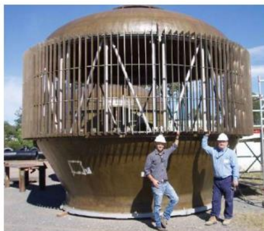
Slika 7: Pokrov »Velocity cap« za odprti zajem (levo) in infiltracijski vodnjaki na obali (desno) (Beninger2010)
