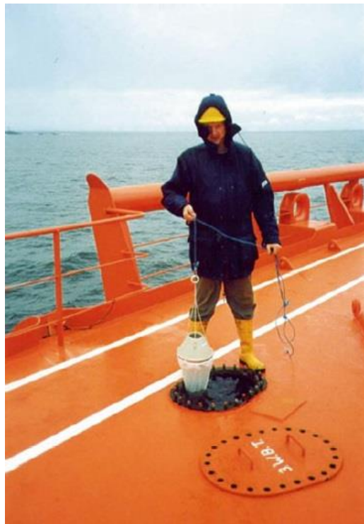
Slika 5: Planktonska mreža za vzorčenje v tankih prek odprtin (David, 2013, str. 34)
