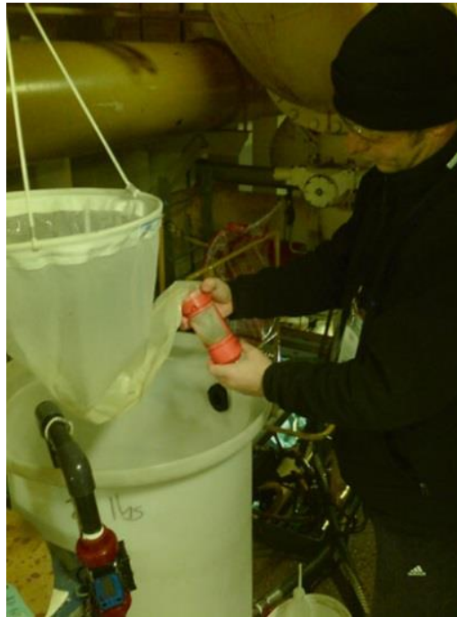
Slika 4: Planktonska mreža za vzorčenje preko balastnih cevnih vodov z odstranljivo filtrirno ploščo (David, 2013, str. 32)
