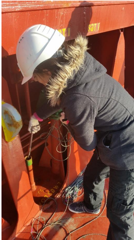
Slika 1: Vzorčenje preko cevi za sondiranje z vzorčevalnikom točkovega vira (Avtor slike: David)
