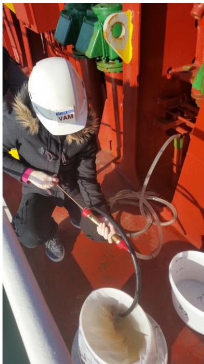
Slika 2: Ročna črpalka – spuščena v tank balastne vode prek cevi za sondiranje (avtor slike: David)
