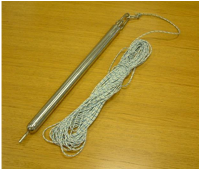
Slika 7: Vzorčevalnik točkovnega vira (Gollasch in David, 2015, str. 198)
