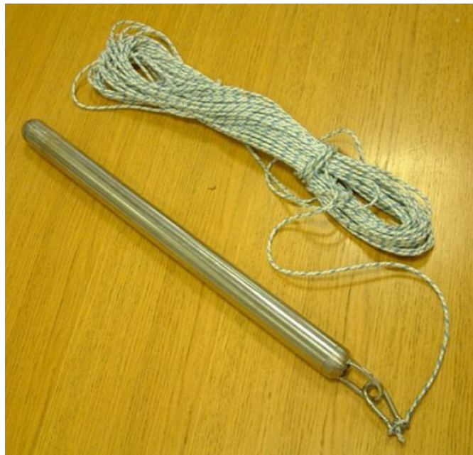
Slika 6: Vzorčevalnik vodnega stolpca, primeren za vzorčenje prek cevi za sondiranje (Gollasch in David, 2015, str. 197)
