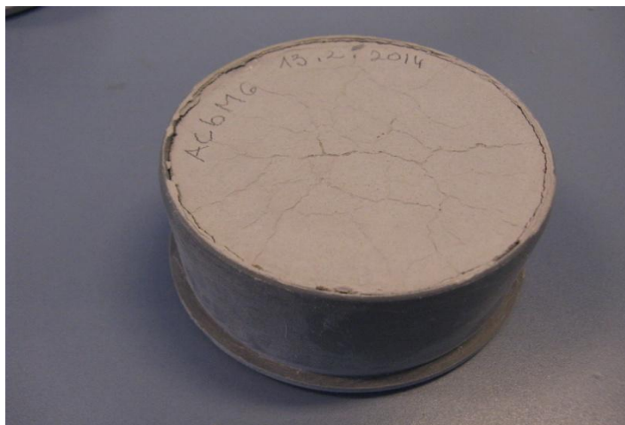
Slika 13: Krušenje roba vzorca mešanice, pripravljenega za meritev krčenja po 24-ih urah
