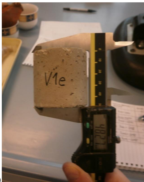
Slika 12: a) Tehtanje preizkušanca, b) Merjenje višine preizkušanca.
