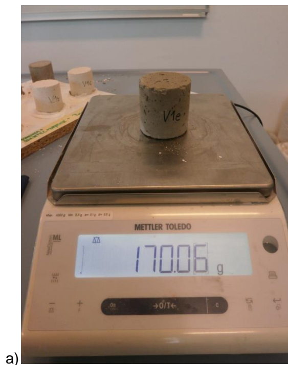
Slika 12: a) Tehtanje preizkušanca, b) Merjenje višine preizkušanca.
