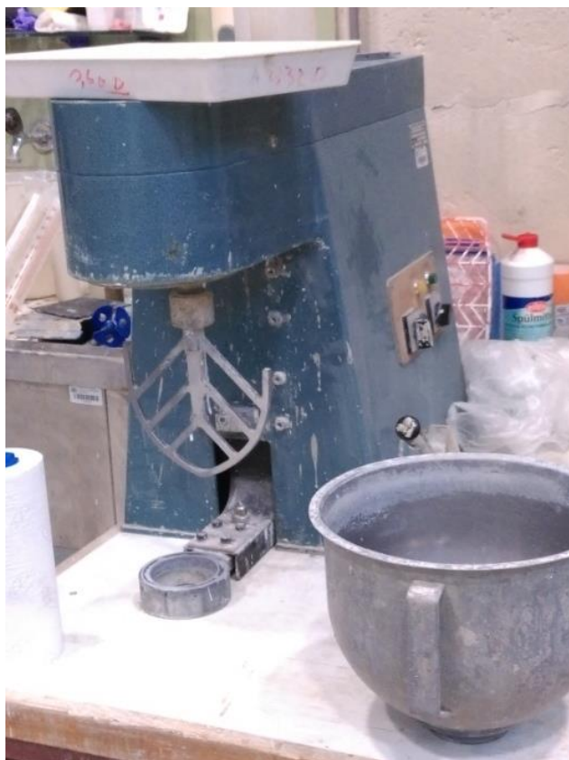
Slika 4: Mešalec RILEM-CEN v Konstrukcijsko - prometnem laboratoriju na FGG.
