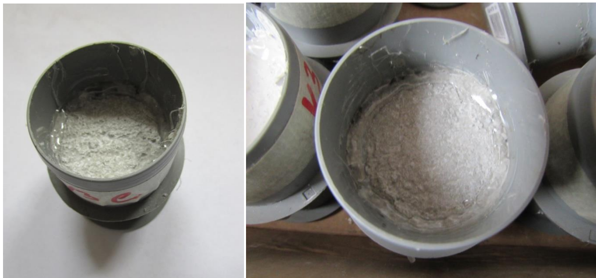
Slika 16: Celoten vzorec s silikonom ob robu.
