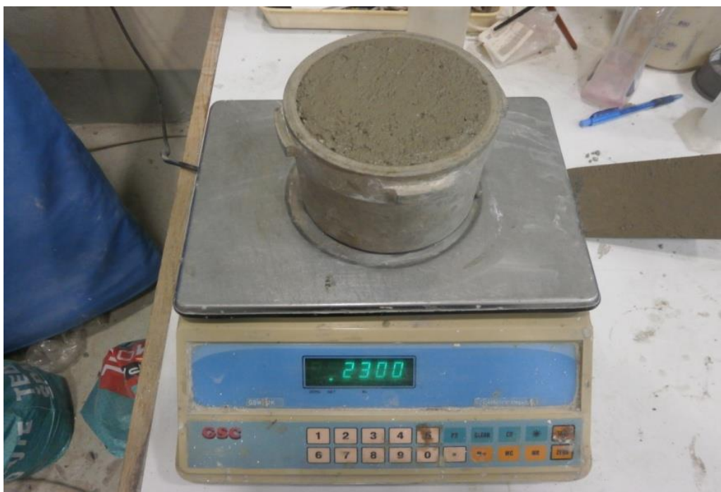
Slika 7: Tehtanje sveže malte v laboratoriju.
