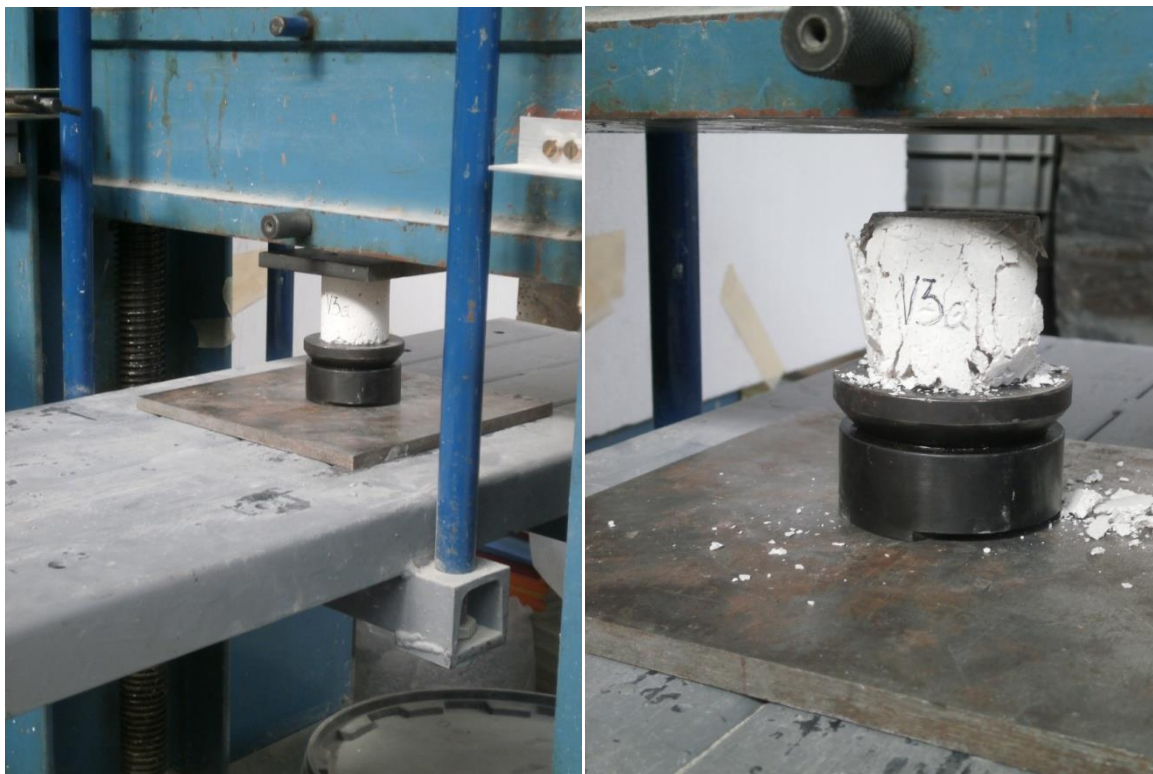
Slika 14: Tlačna porušitev valja v preši.
