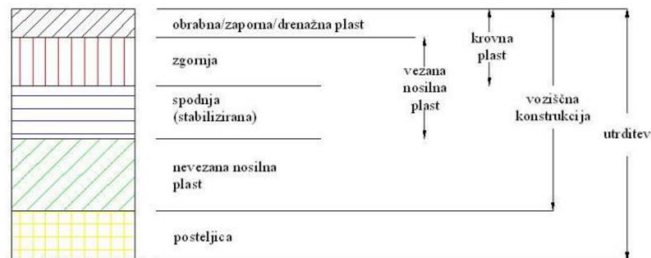
Slika 5: Utrditve sodobnih vozišč (Slokan, 2005).
