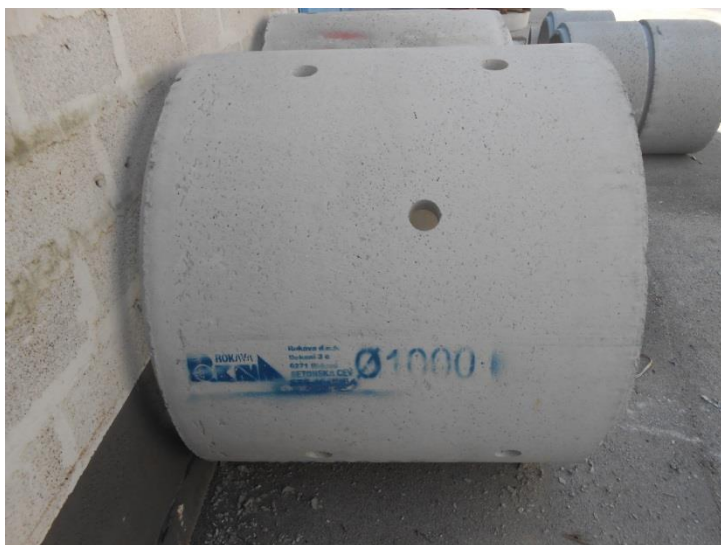
Slika 41: Perforirana betonska cev.
