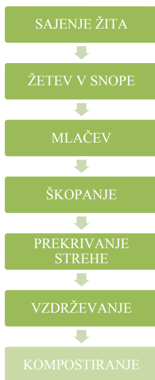
Slika 4: Shema poteka izdelave in vzdrževanja slamnate strehe
