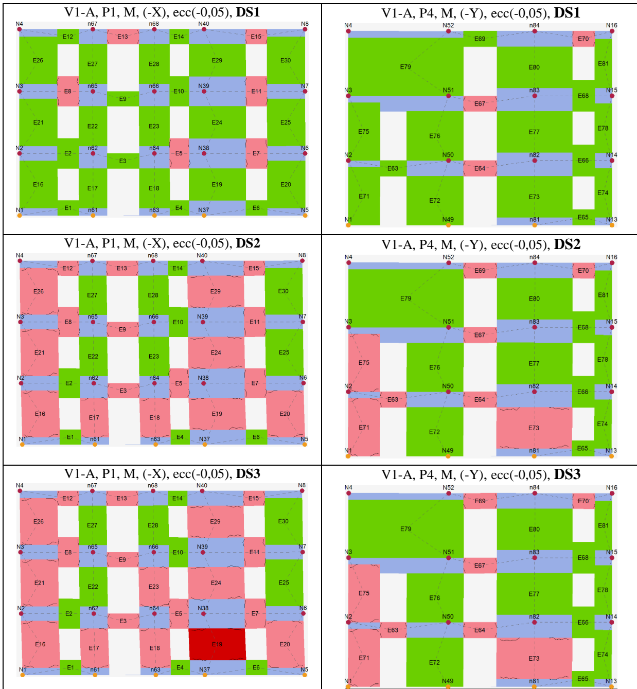
Slika 4.9: Razvoj poškodovanosti zidnih elementov (steni P1 in P4) pri treh karakterističnih mejnih stanjih DS1-DS3 za varianto V1-A.
