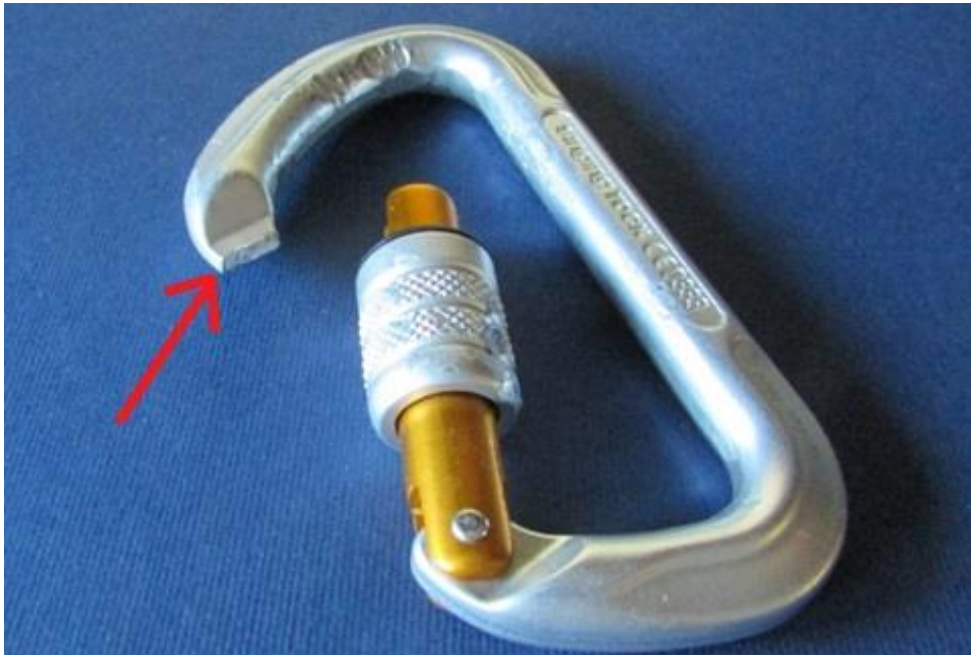
Slika 35: Vponka po končanih testih in poružitvi v trgalnem stroju.
