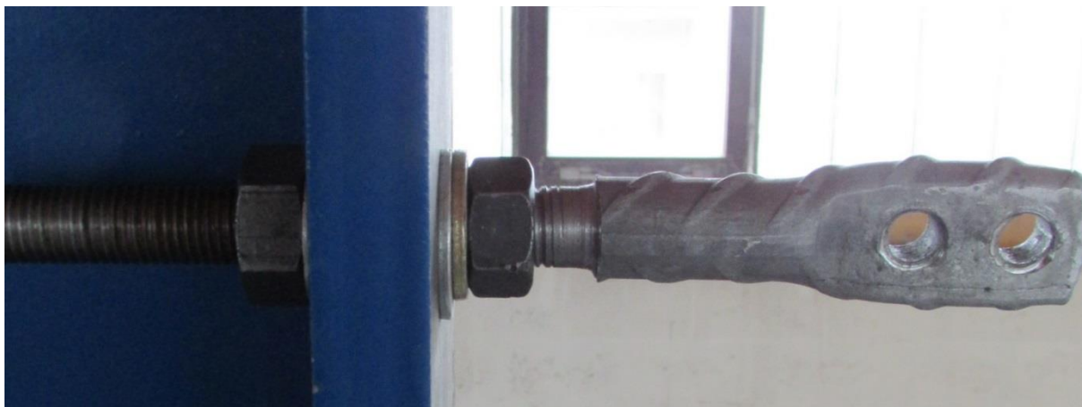
Slika 27: Sidrni klin pri tirolskem sistemu, ki smo ga uporabili pri testih.
