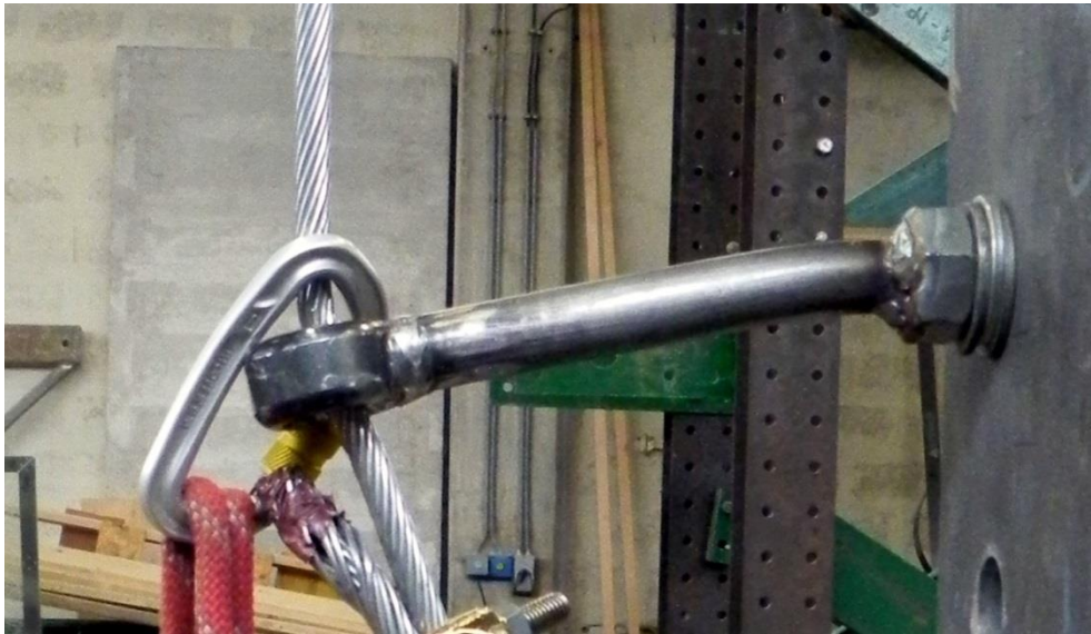
Slika 28: Sidni klin pri prednapetem sistemu, ki smo ga uporabili pri testih.
