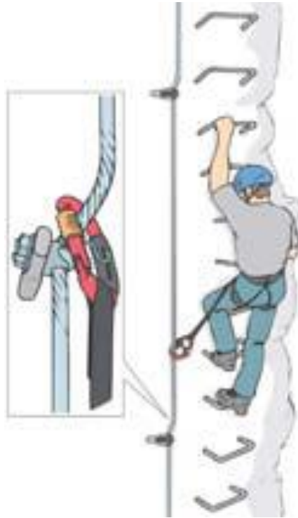
Slika 10: Pozožaj vponke pri tirolskem jeklenem sistemu (Semmel, C., Hellberg, F., Riha, E. 2009).
