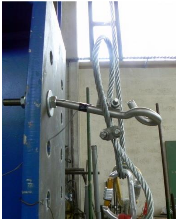
Slika 37: Upogib sidrnih klinov pri francoskem sistemu je bil največji (6 cm).
