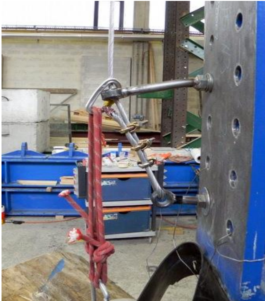
Slika 39: Spodnji sidni klin prednapetega jeklenega sistema po testu z vponko manjšega premera.
