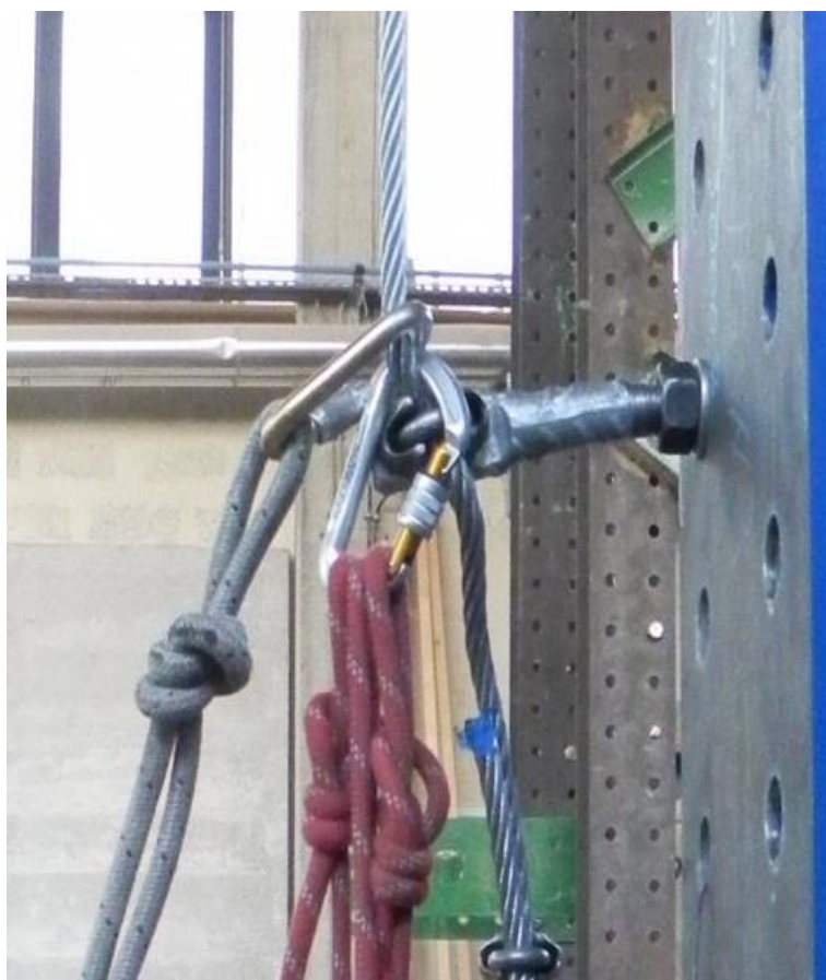
Slika 38: Spodnji sidrni klin tirolskega jeklenega sistema po testu.
