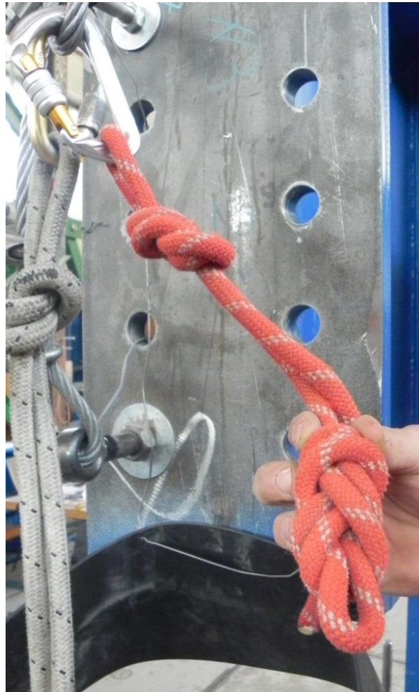
Slika 33: Enojna dinamična vrv, ki je bila uporabljena na testih.
