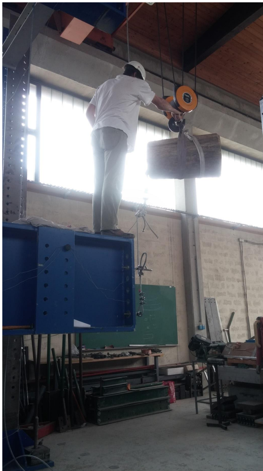
Slika 32: Jeklana konstrukcija s ferato in klado tik pred testom z višine 2,5 m.
