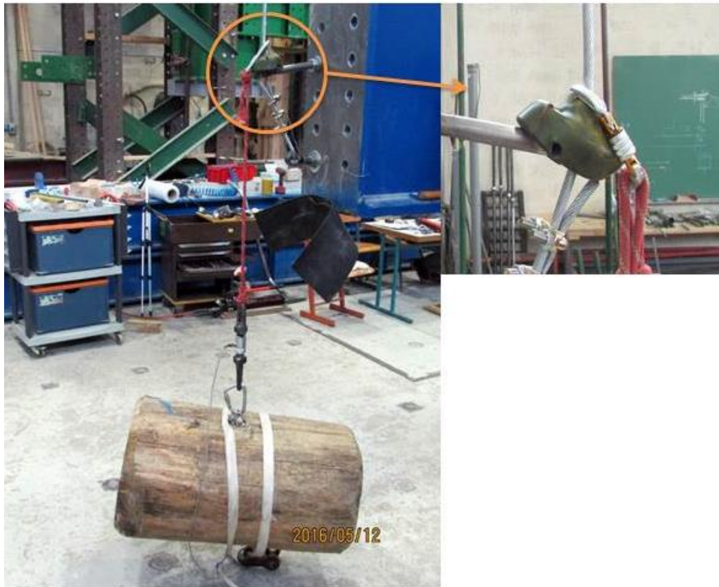
Slika 40: Spodnji sidrni klin prednapetega jeklenega sistema z varnostnim stožcem po testu.
