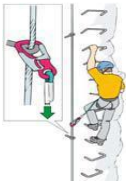
Slika 12: Položaj vponke pri prednapetem jeklenem sistemu (Sommel, C., Hellberg, F., Riha, E. 2009).
