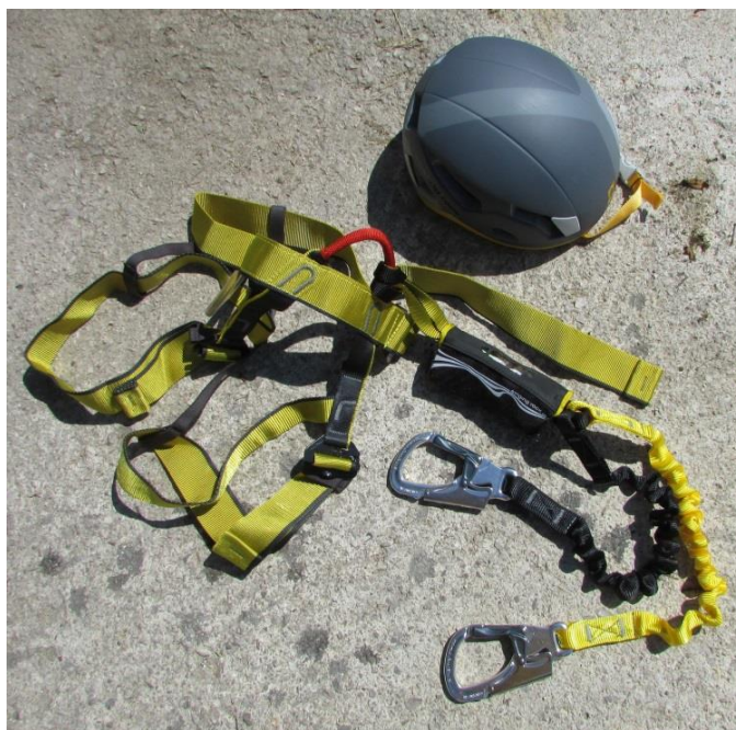
Slika 23: Samovarovalni komplet, ki ga sestavljajo: čelada, plezalni pas, popkovina z blažilcem in dvema krakoma.
