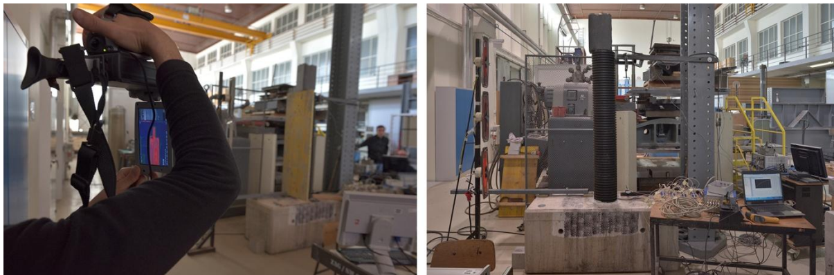
Slika 28: Levo: preverjanje enakomernosti temperaturne porazdelitve na površini deske pred stebrom; desno: ogrevanje stebra in merjenje pomika med poskusom
