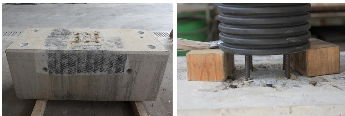
Slika 12: Levo: betonski blok; desno: sidranje armaturnih palic v betonski blok
