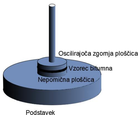
Slika 2-14 Dinamični strižni reometer (laboratorij ZAG Ljubljana)
