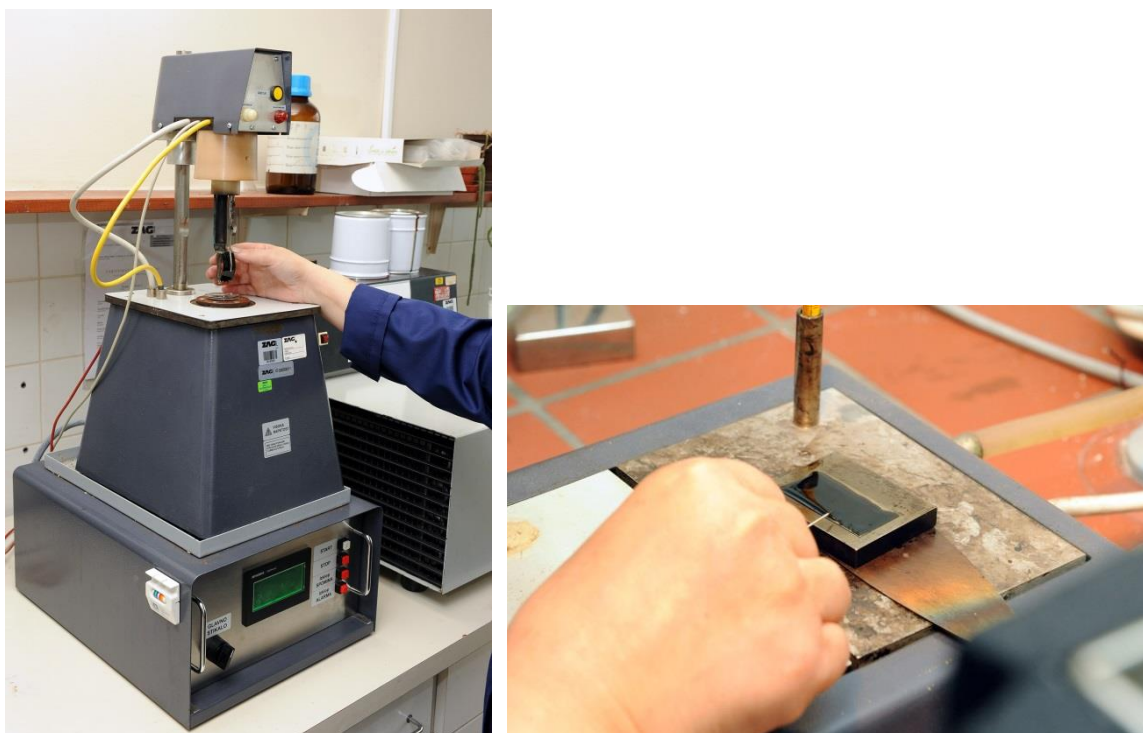
Slika 2-3 Določevanje pretrgališča po Fraass-u (laboratorij ZAG Ljubljana)
