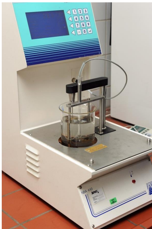
Slika 2-2 Določanje zmehčišča - metoda prstana in kroglice (laboratorij ZAG Ljubljana)
