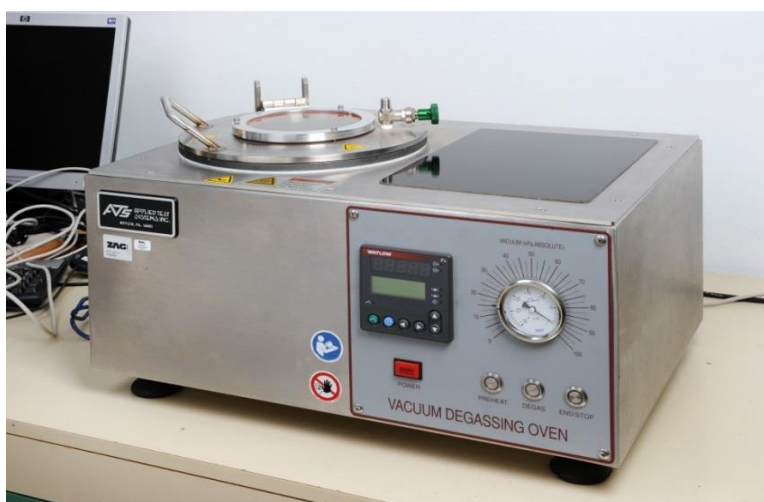
Slika 2-9 PAV odstranjevanje zračnih mehurčkov
