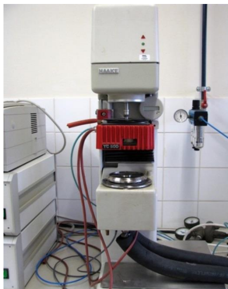
Slika 2-14 Dinamični strižni reometer (laboratorij ZAG Ljubljana)
