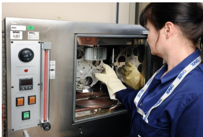
Slika 2-7 RTFOT Določanje odpornosti proti otrjevanju pod vplivom toplote in zraka
