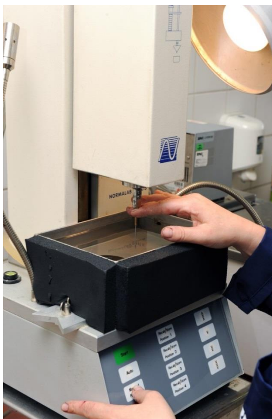
Slika 2-1 Določevanje penetracije z iglo (laboratorij ZAG Ljubljana)
