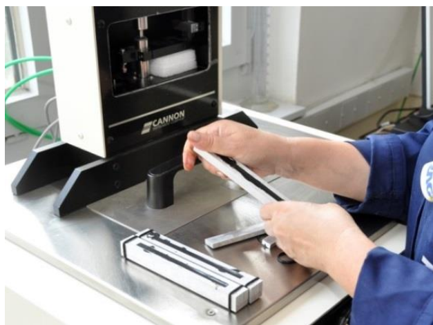
Slika 2-10 Ugotavljanje upogibne togosti z BBR po SIST EN 14771
