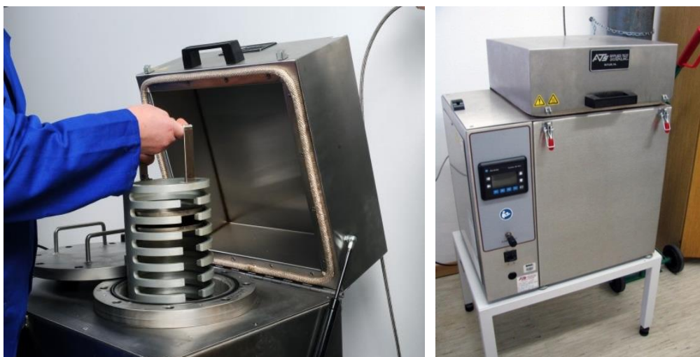
Slika 2-8 PAV pospešeno staranje v komori
