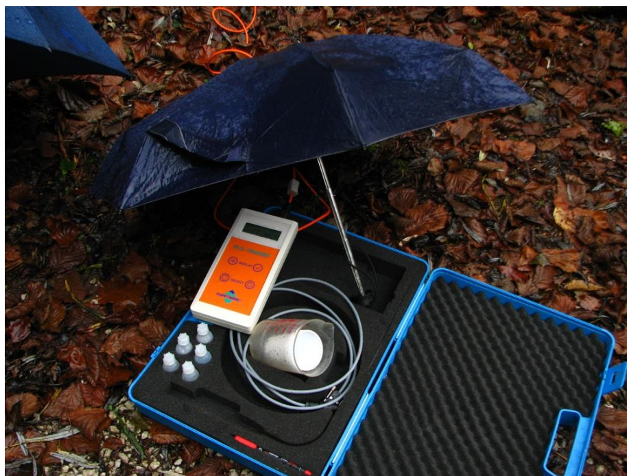
Slika 11: Instrument za merjenje pretoka Flo-Tracer (foto: Mole, 2014)
