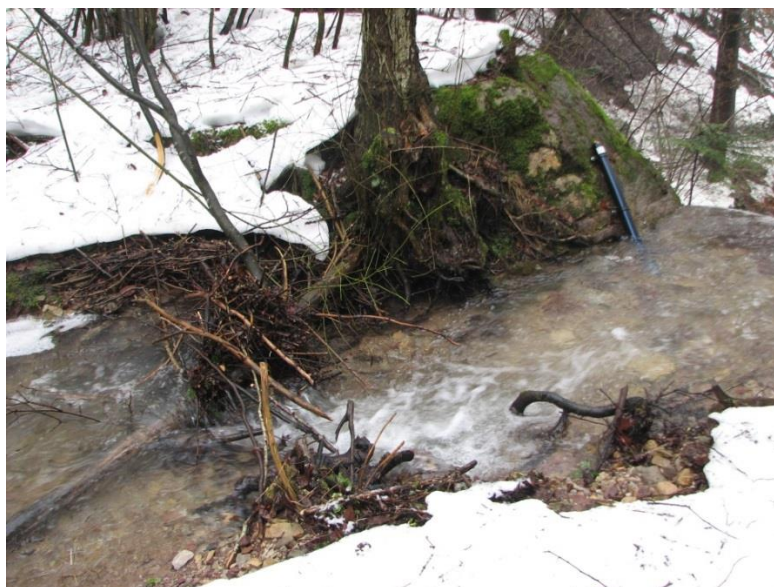
Slika 24: Tlačna sonda, locirana v toku sosednjega Kuzlovca blizu iztoka v Božno (foto: Mole, 2014)
