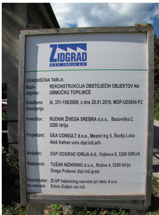
Slika 5: Primer gradbiščne table
