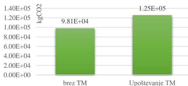
Grafikon 45: Vpliv toplotnih mostov na sproščanje emisij stavbe Graph 45: thermal bridges influence on carbon emissions of the building
